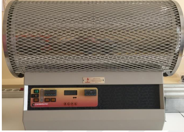
Şekil 3.2. Omik kontak yapımı işleminde kullanılan kuartz tüplü tavlama fırını.
