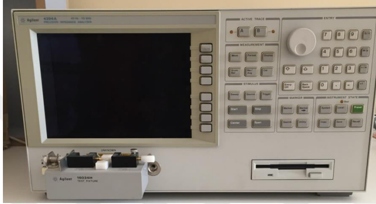
Şekil 4.9. C-V-f ve G-V ölçüm işlemleri için kullanılan “AGILENT 4294A PRECISION IMPEDANCE ANALYZER” cihazı.
