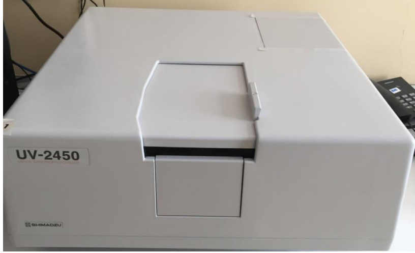
Şekil 4.14. Optik soğurma ve geçirgenlik ölçüm işlemleri için kullanılan UV-Vis spektrofotometre cihazı.
