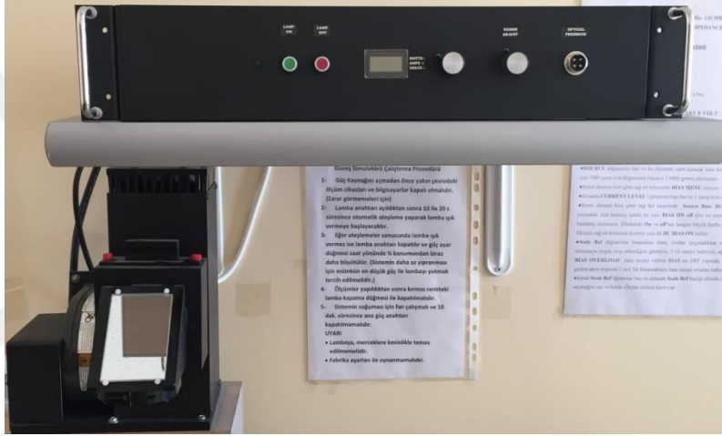
Şekil 4.2. Güneş pili karakterizasyonunda kullanılan güneş simülatörü.
