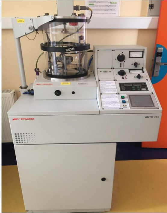
Şekil 3.1. Termal buharlaştırmayla ince film oluşturmak için 'EDWARDS AUTO 306' vakum kaplama cihazı.
