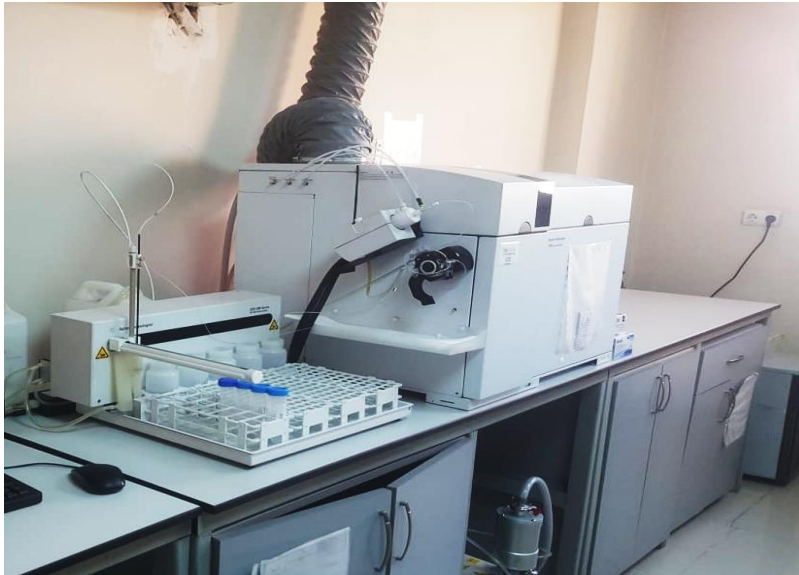
Şekil 3. 16. Sodyum, potasyum, kalsiyum ve magnezyum ölçümünde kullanılan ICP - MS ( Inductively Coupled Plasma - Mass Spectrometer ) cihazı.
