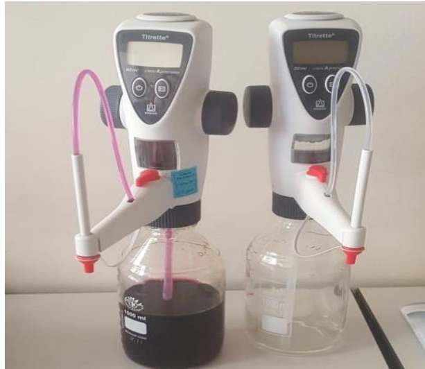
Şekil 3. 15. Karbonat ve bikarbonatın tayininde titrasyon amacıyla kullanılan cihaz.
