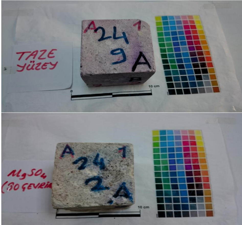
Şekil 3.5. Tuz kristallenmesi deneyi öncesinde ve 30 Çevrim sonrasında killi kireçtaşında değişen pürüzlülüğe ait bir görüntü.
