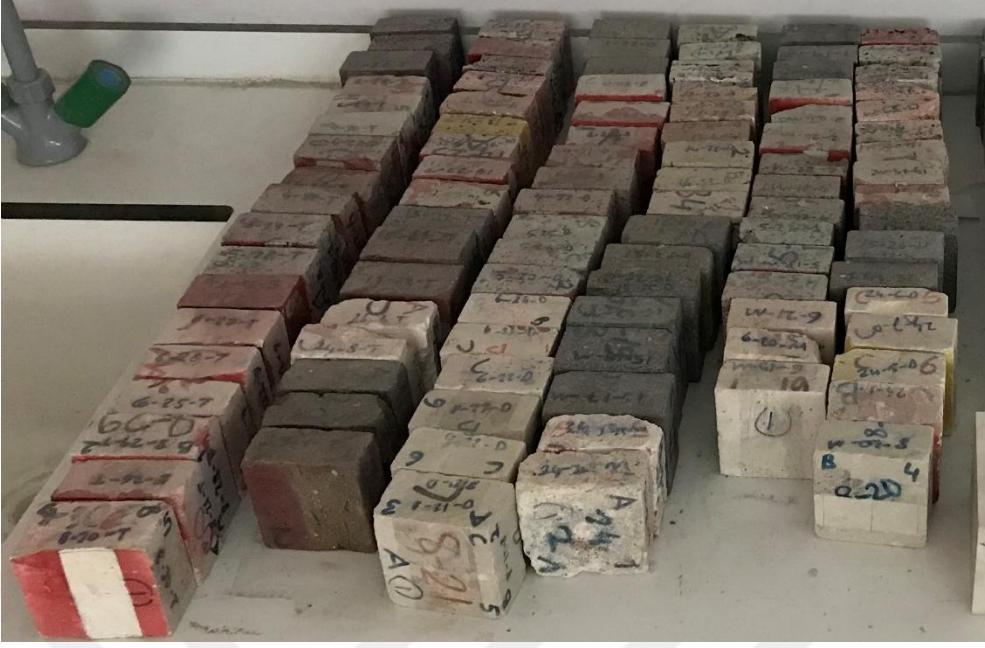
Şekil 3.8. GDA deneyine tabi tutulmuş numunelerde oluşan oluklara ait bir görüntü.
