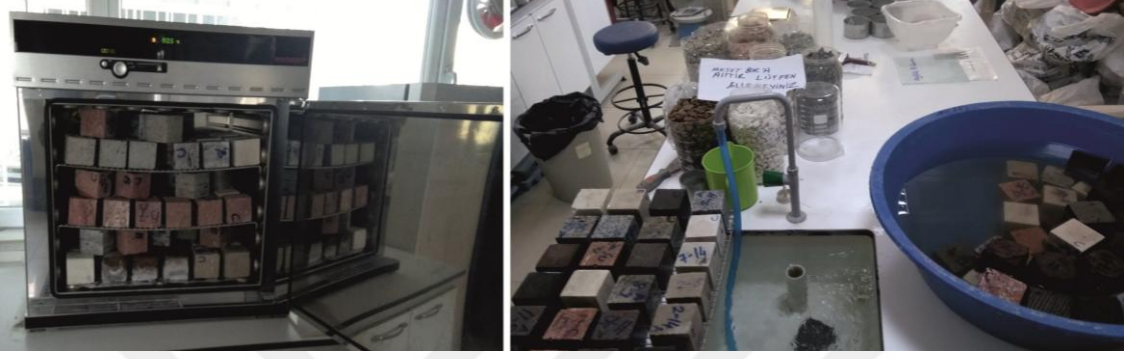
Şekil 3.4. Tuz kristallenmesi deneyine ait kurutma ve çözeltide bekletme çalışmalarına ait görüntüler.
