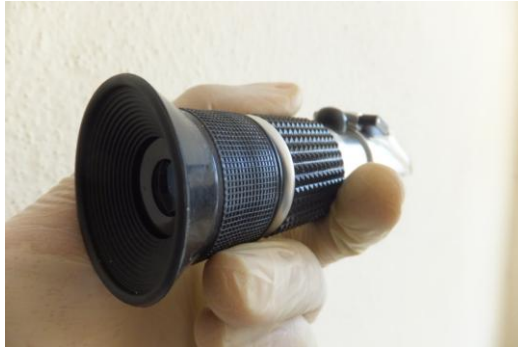
Şekil 3.10. SÇKM ölçüm aleti ile suda çözülebilen kuru madde oranı belirlenmesi.
