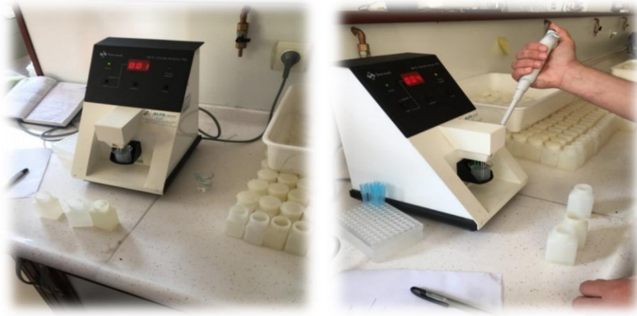
Şekil 3.15. Kloridometre ile Cl analizinin yapılması
