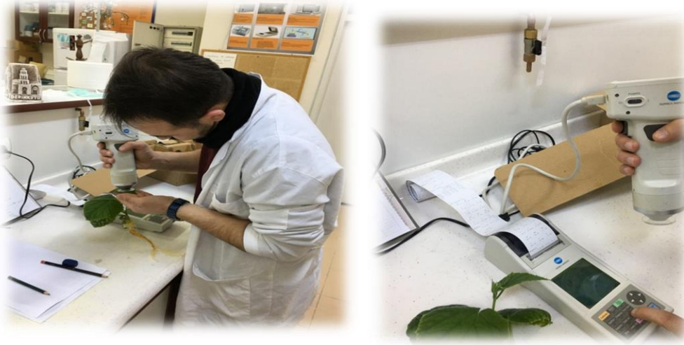
Şekil 3.17. Bitkilerin renk ölçer yardımıyla renk analizlerinin yapılması.
