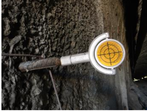
Şekil 4.39. Başkale Tüneli'nde deformasyon ölçümünde kullanılan bir target.
