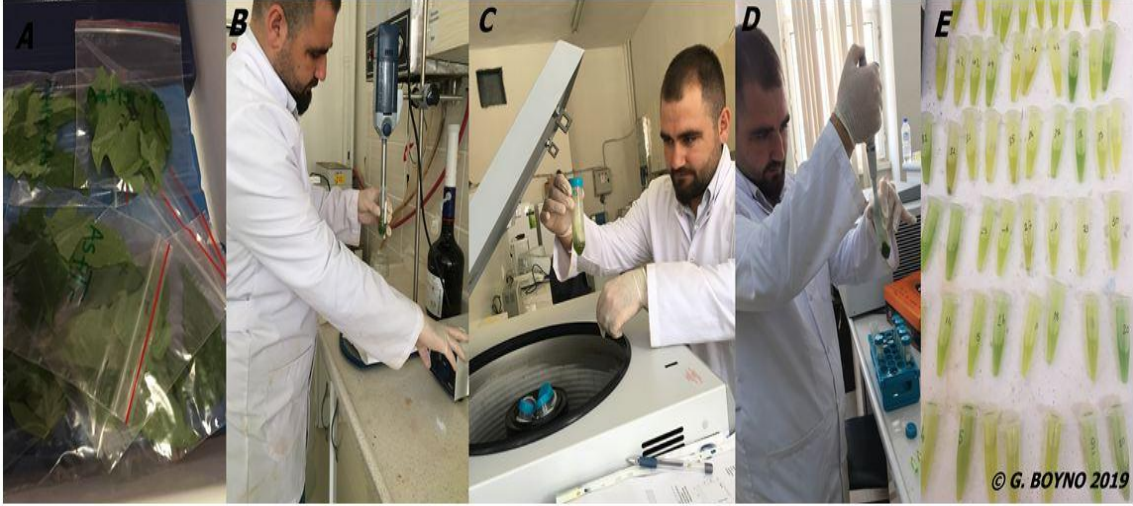
Şekil 3.19. Bitki ekstraktlarının hazırlanması A. bitki yapraklarının muhafazası, B. örneklerin homojenizatörde parçalanması C. parçalanmış örneklerin santrifüj edilmesi, D. ekstrakt kısmının alınması, E. ekstraktların tüplere aktarılıp muhafazası.
