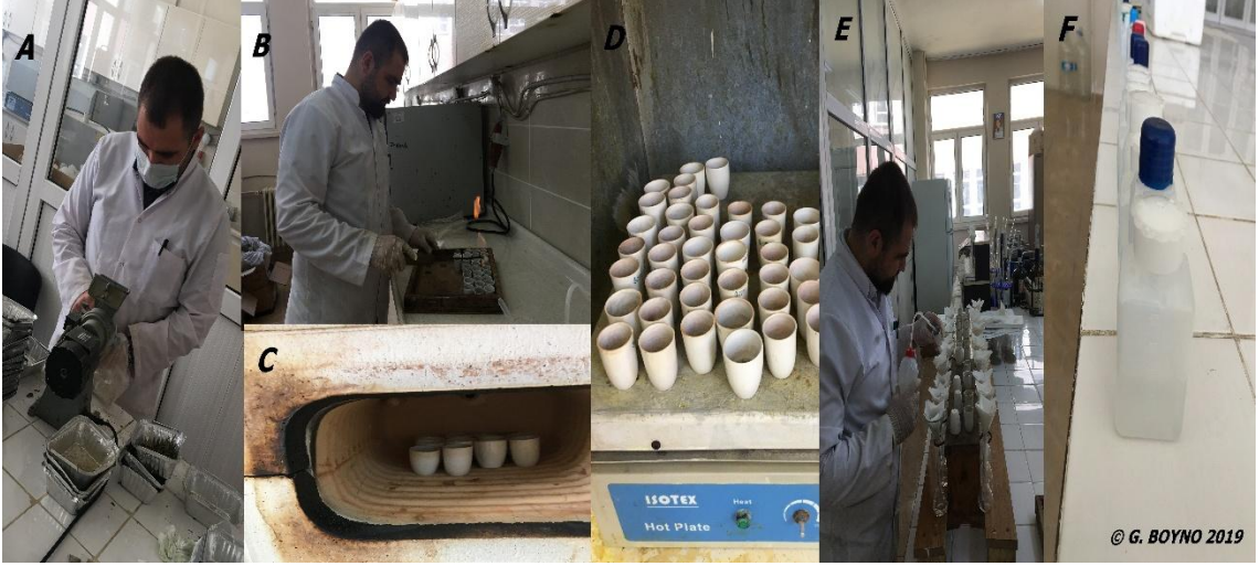
Şekil 3.22. Fosfor analizi işlemi A. kurutulmuş örneklerin parçalanması, B. ön yakma işlemi, C. kül fırınında yakma, D. sıcak hatta bekletme, E. balon jojelerde süzme işlemi, F. süzüklerin ekstrakt kaplarına toplanması.
