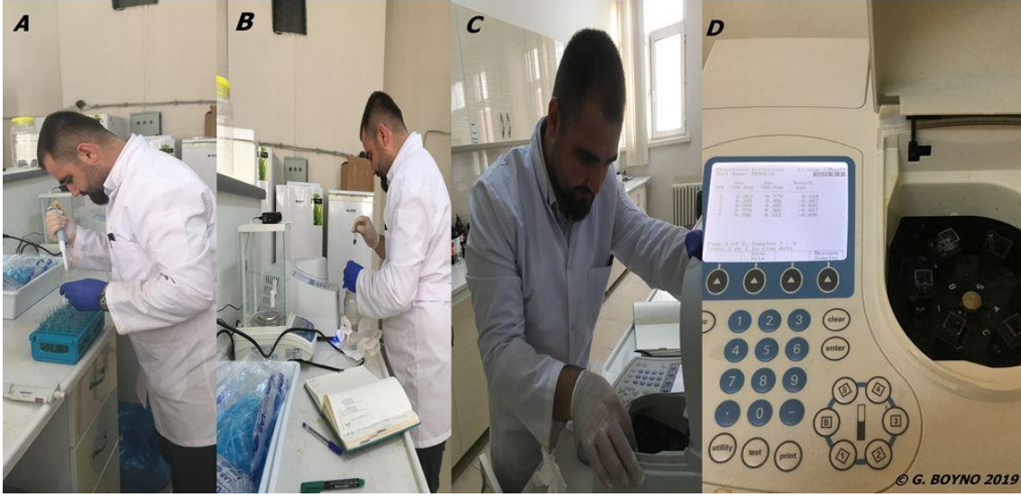
Şekil 3.20. Toplam fenolik madde miktarının belirlenmesi A. bitki ekstraktlarının cam tüplere aktarımı, B. çözeltilerin eklenmesi C. spektrofotometrede okuma işlemi, D. spektrofotometre cihazında sonuçların eldesi.
