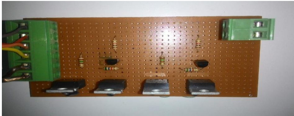
Şekil 4.9. Projede tasarlanan H-Bridge devresi.
