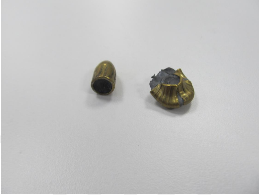
Şekil 4.11. (solda) 9,19 merminin atış öncesi hali (sağda) 9,19 merminin atış sonrası hali.
