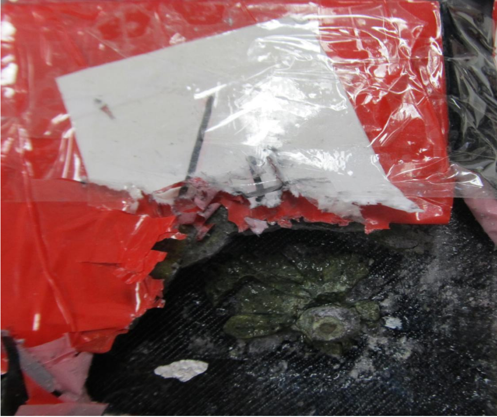
Şekil 4.8. Balistik test sonucu prototip.
