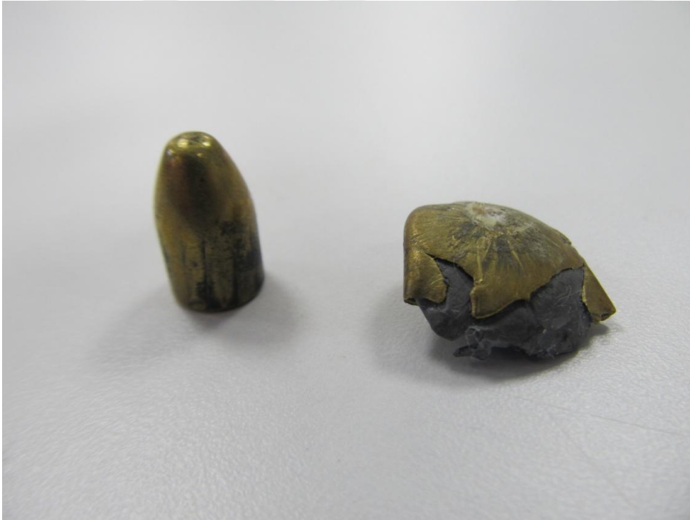
Şekil 4.12. (solda) 9,19 merminin atış öncesi hali (sağda) 9,19 merminin atış sonrası hali.
