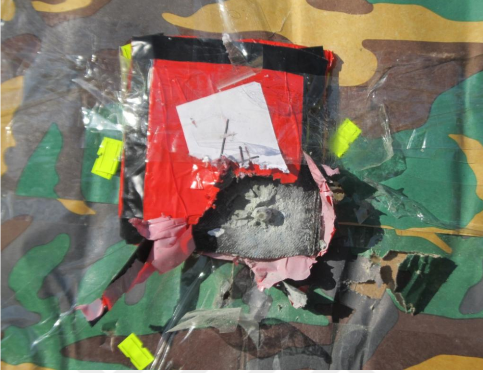
Şekil 4.7. Numunenin balistik testin hemen sonraki görüntüsü.
