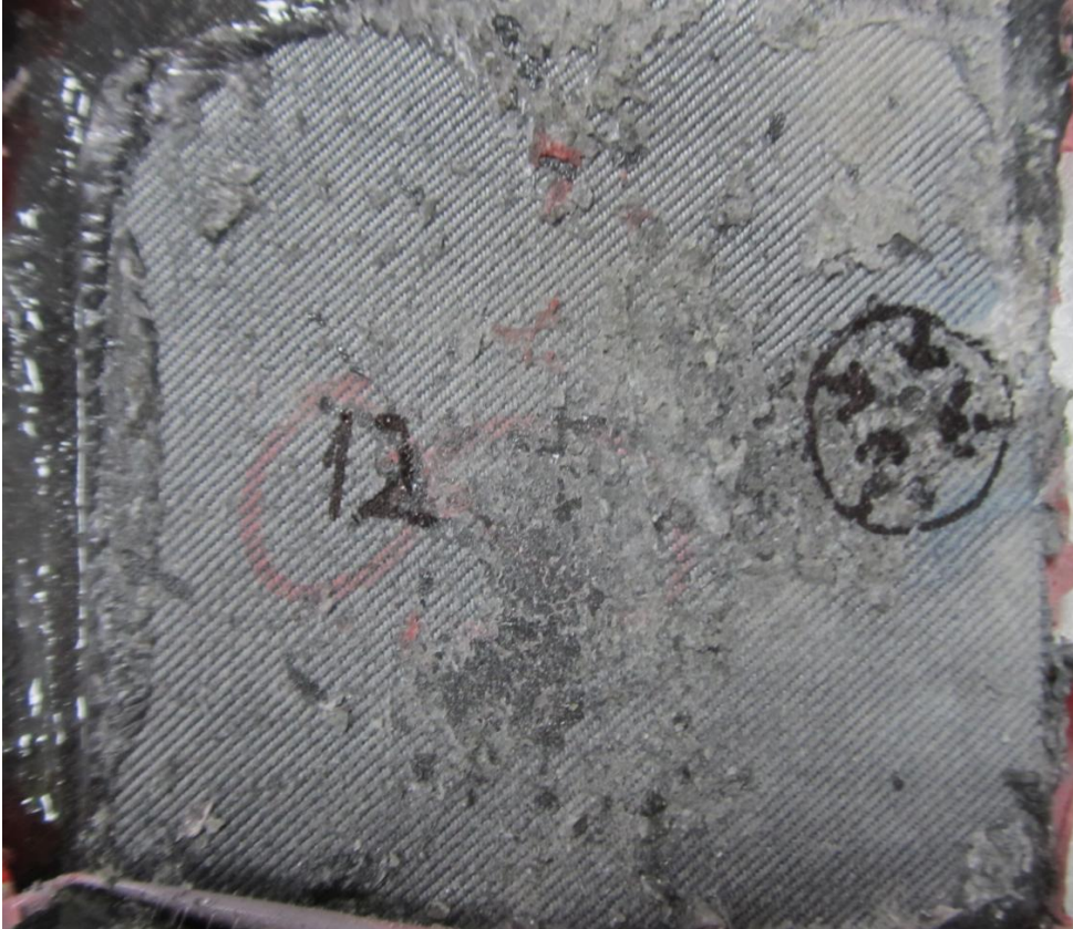
Şekil 4.10. Balistik test sonucu prototipin son hali.
