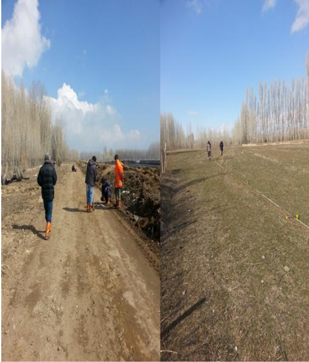
Şekil 4.10. Jet Grout öncesinde atıksu arıtma alanında yapılan jeofizik çalışmalar.
