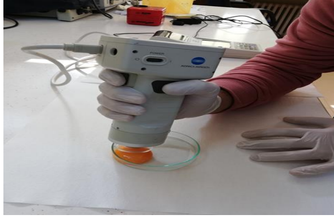
Şekil 3.3. Konica minolta CR-400 renk ölçüm cihazı ile yumurtaların renk skala değerlerinin ölçülmesi.
