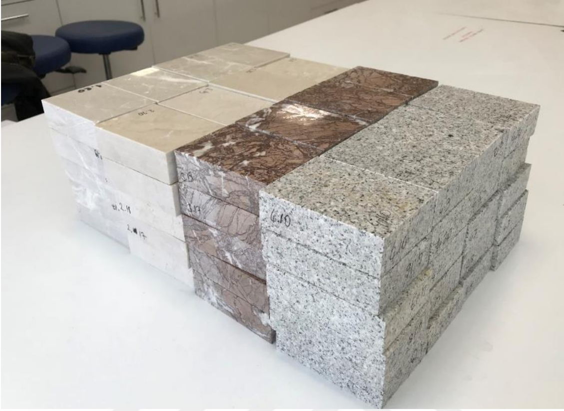
Şekil 3.3. Deneylerde kullanılan dikdörtgen yüzey alanına sahip örneklere ait bir görüntü.
