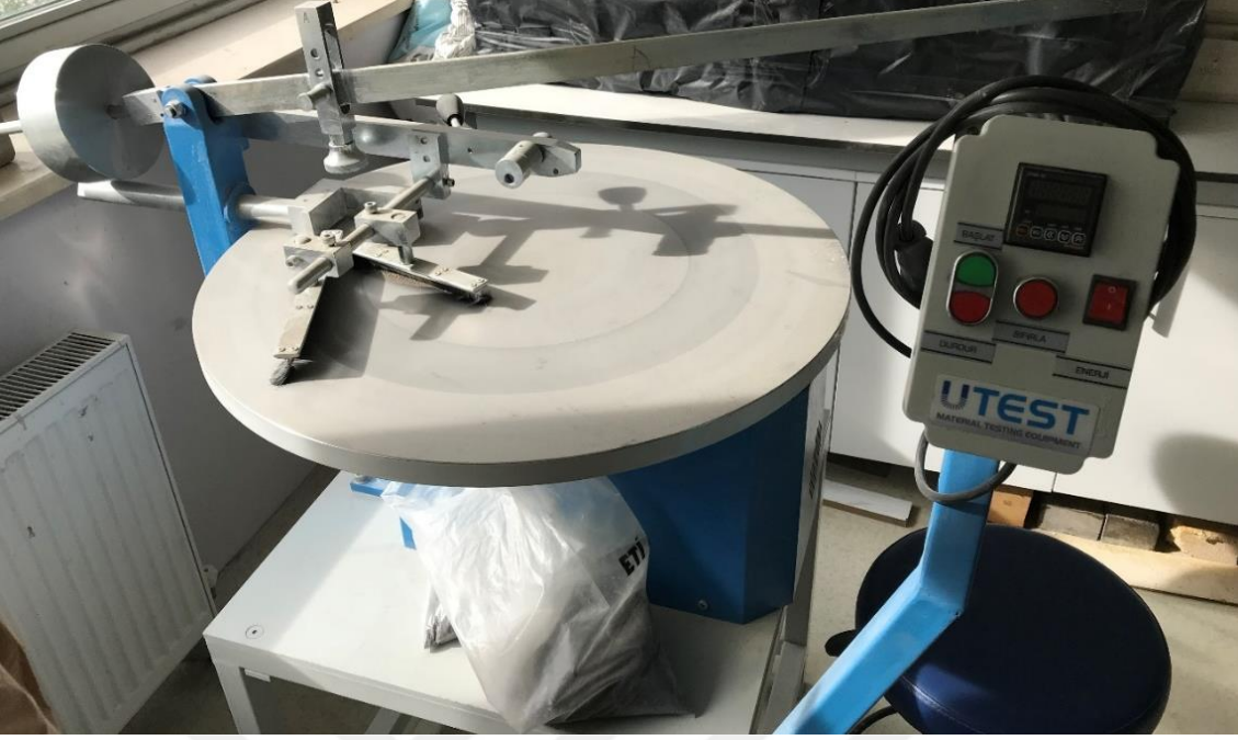
Şekil 3.7. Böhme Aşındırma cihazına ait bir görüntü.
