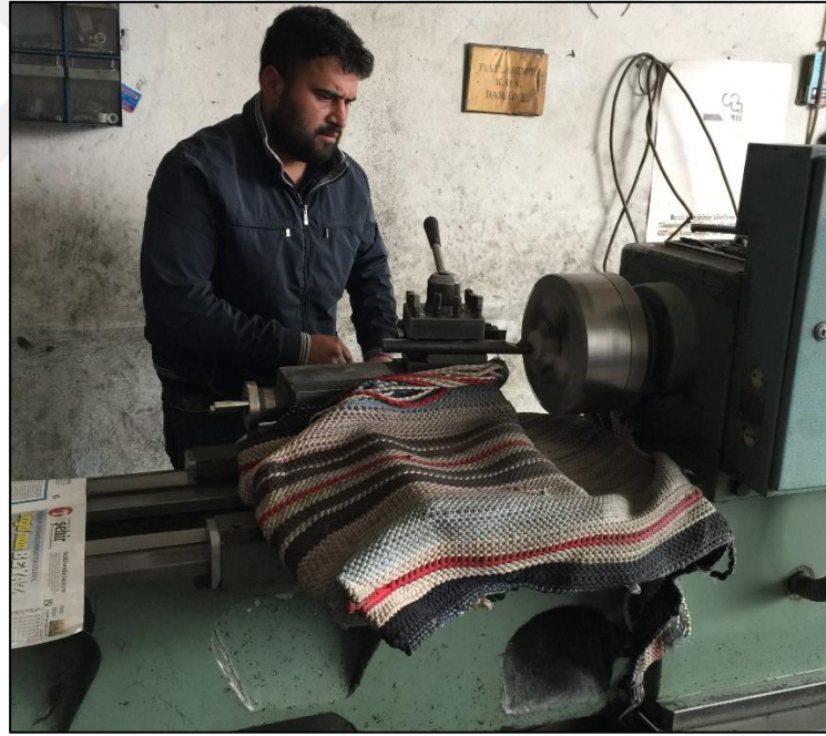
Şekil 3.7. Karotların alt ve üst yüzeylerinin düz hale getirilmesinde kullanılan yüksek hassasiyetli torna makinasına ait bir görüntü.
