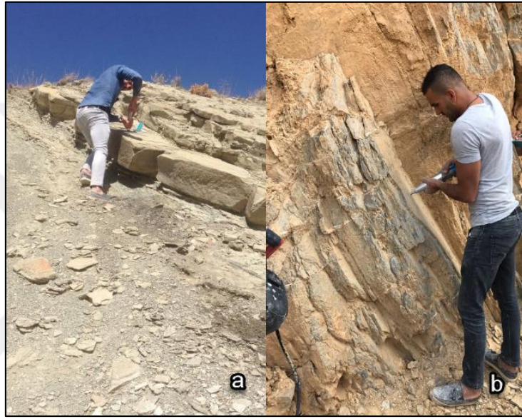
Şekil 3.16. Schmidt çekici ile çalışma alanlarının taze ve ayrılmış yüzeylerinden dayanımın belirlenmesi. KRBSŞ çalışma alanına ait ölçüm (a), ÇKRC çalışma alanına ait ölçüm (b).
