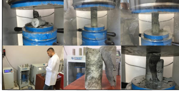
Şekil 4.12. KRBS ve ÇKRC çalışma alanlarına ait silindirik örnekler üzerinde uygulanan tek eksenli basınç dayanımı deneyine ait görüntüler.
