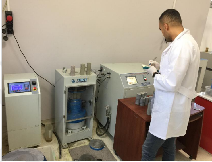
Şekil 3.9. KRBS ve ÇKRC alanlarından alınan karot örneklerine uygulanan tek eksenli basınç dayanımı testi.
