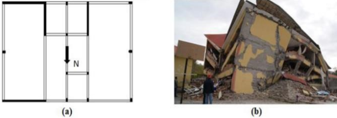
Şekil 3.10. a. Plan Düzensizliğine sahip bir binanın zemin kat plan görünüşü, b. binanın depremden sonraki hasar durumu (Erdil ve Ceylan, 2019).
