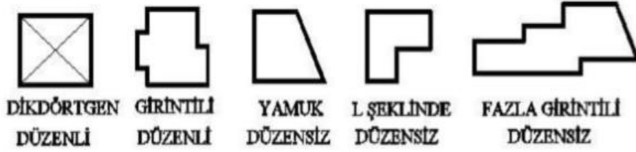
Şekil 3.9. Binalarda plan düzensizliği durumları (Riskli Yapıların Tespit Edilmesine İlişkin Esaslar, 2019).
