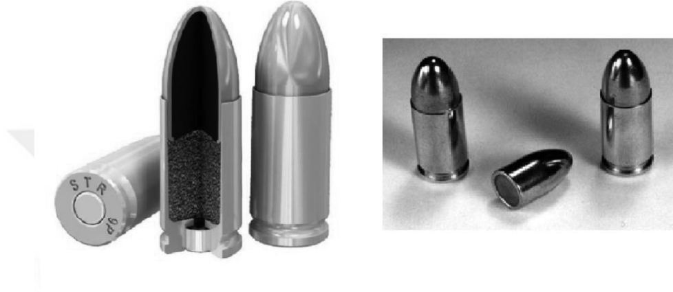
Şekil 1.4. NIJ 3A standartlarında kullanılan küresel uçlu mermi.
