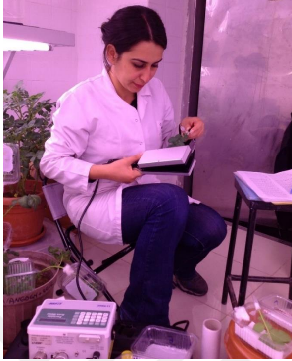
Şekil 3.3. Arbusküler mikorhiza uygulamasının L. decemlineata 'nın beslenme kapasitesi üzerine etkisini ölçmek için kullanılan LI-3000A portatif yüzey alanı ölçme cihazı (LiCor, Lincoln, NE).
