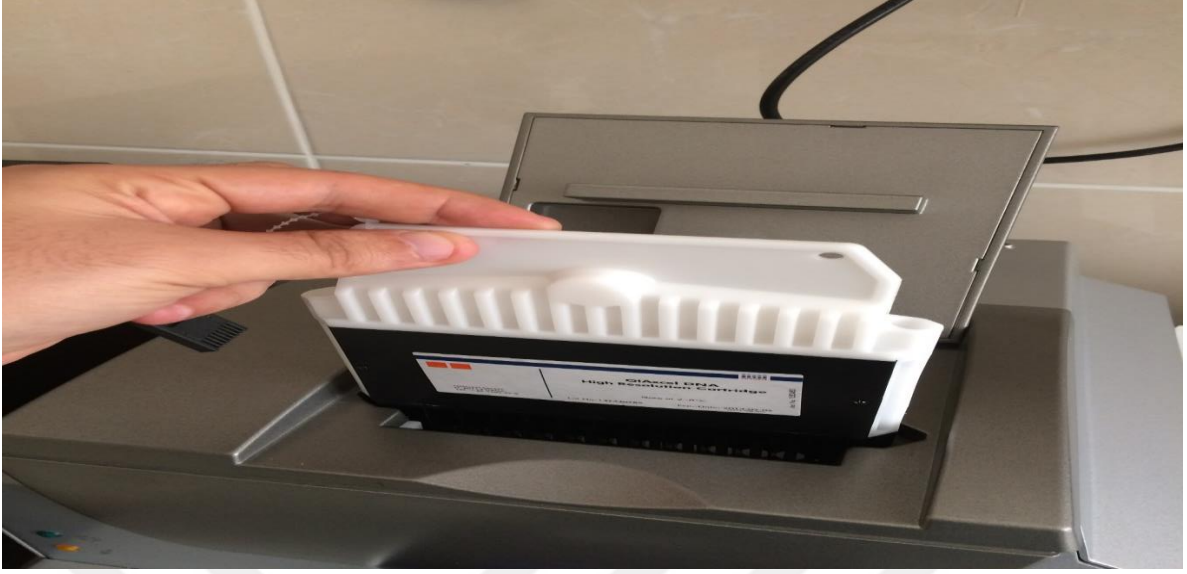
Şekil 28. DNA High Resolution Kiti'nin cihaza yerleştirilmesi
