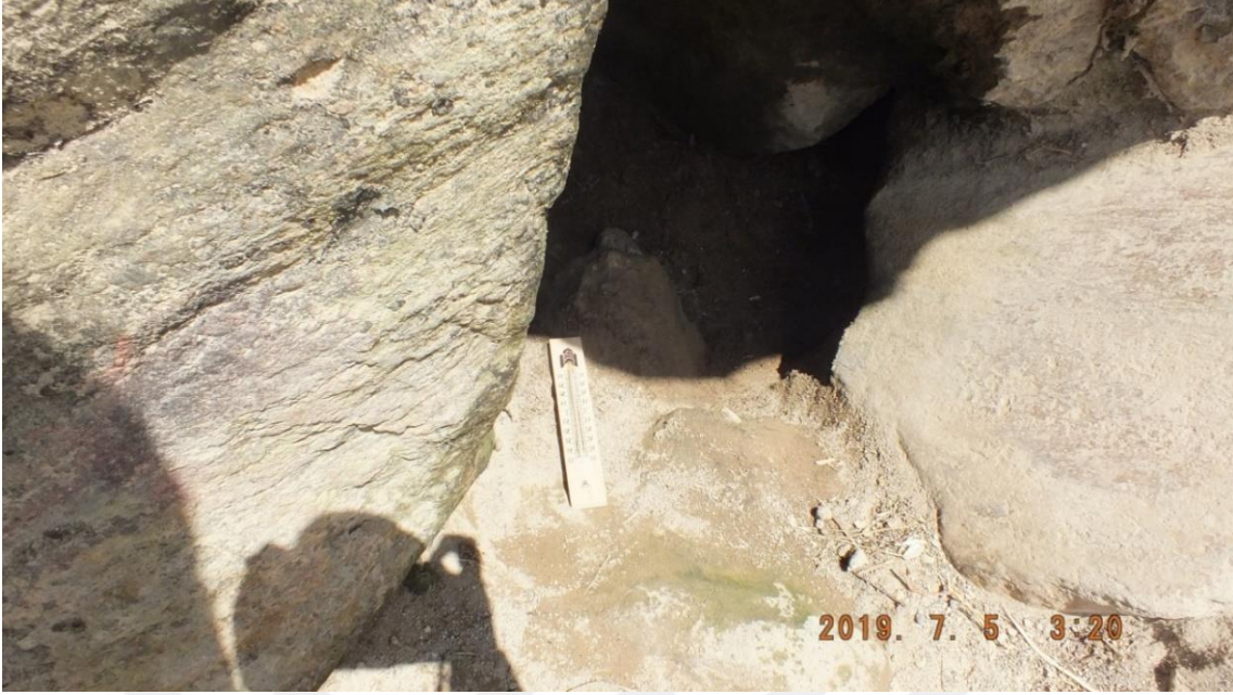
Şekil 4.19. Buhar bacasında termometre ile sıcaklık ölçümü.
