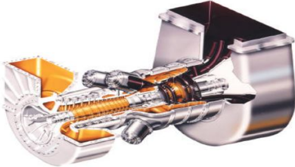
Şekil 1.2. Nikel esaslı süper alaşımların etkin olarak kullanıldığı gaz türbin motoru (Loria, 1992).
