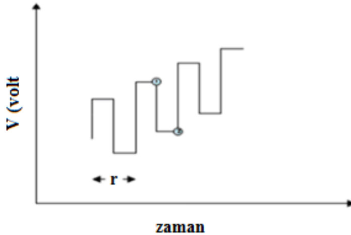
Şekil 1.15. Kare dalga voltametri potansiyel-zaman grafiği. Basamaklı sinyalde her basamağın boy ve puls periyodu eşit olup bu yaklaşık 5 ms civarındadır.
