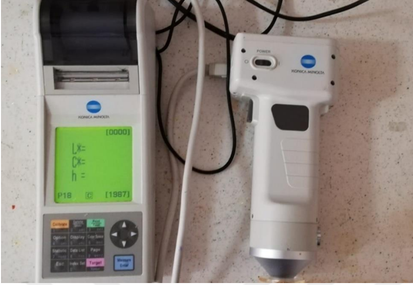
Şekil 3.5. Minolta CR-400 marka renk ölçer.
