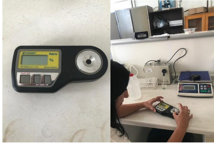
Şekil 3.5. A: Dijital refraktometre, B: Dijital refraktometre ile suda çözünen kuru madde ölçümü (Yıldırım, 2019).
