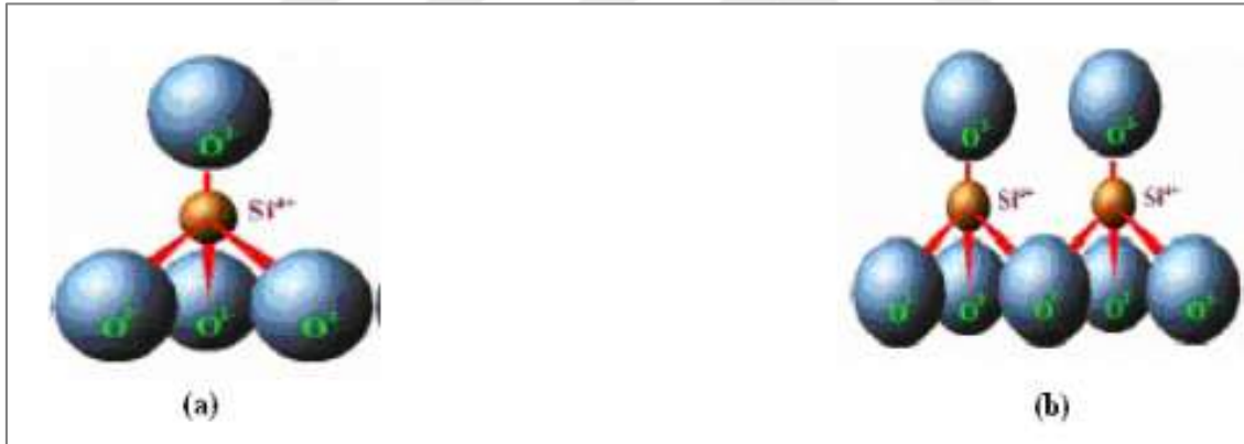
Şekil 1.2. a) Bir tane tetrahedral hücre (Tetrahedron), b) Tetrahedronların bir araya gelerek meydana getirdiği tetrahedral katman.
