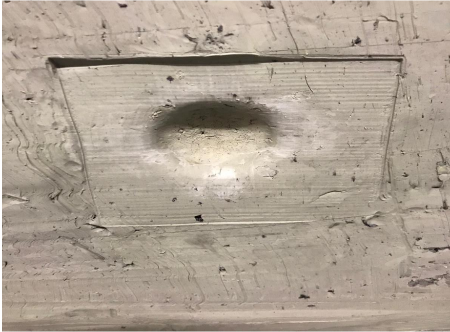
Şekil 4.23. Al 2 O 3 zırh paneline atış sonrası destek malzemesinde oluşan travma derinliği.
