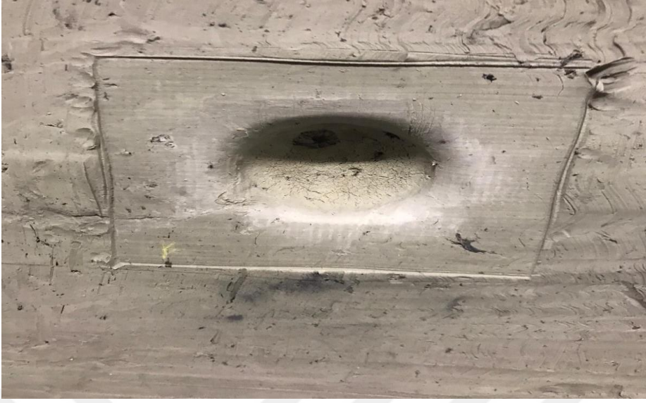
Şekil 4.24. B 4 C zırh paneline atış sonrası destek malzemesinde oluşan travma derinliği.
