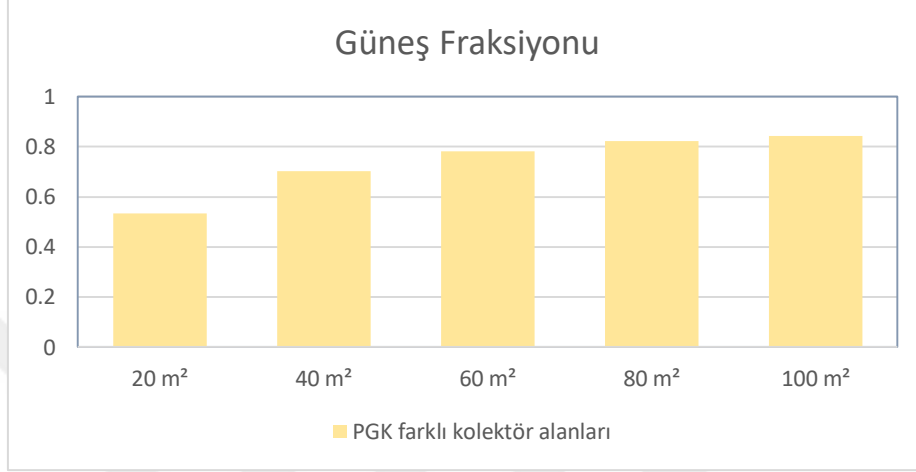
Şekil 4.39. Farklı yüzey alanlarında VTGK kullanımı sonucunda ılık sera sisteminin güneş fraksiyonu değişimi.
