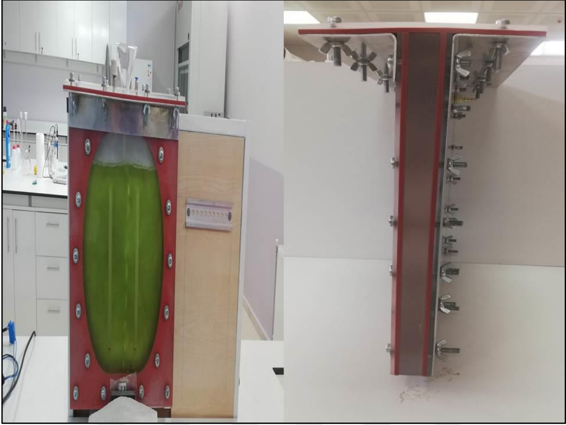
Şekil 4. 2. Düz panel hava kaldırmalı fotobiyoreaktör'ün tamamlandıktan sonra önden ve yandan görünüşü.
