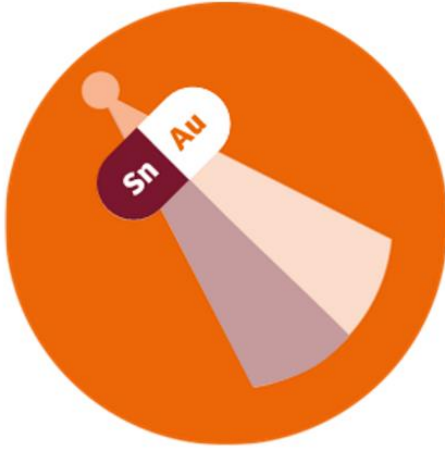
Şekil 9. Çift ışınlı DEBT'de x-ışını, ışınını farklı enerjileri iki ışına bölmek için iki ayrı filtre olan Kalay (Sn) ve Altın (Au)'ı kullanılır.
