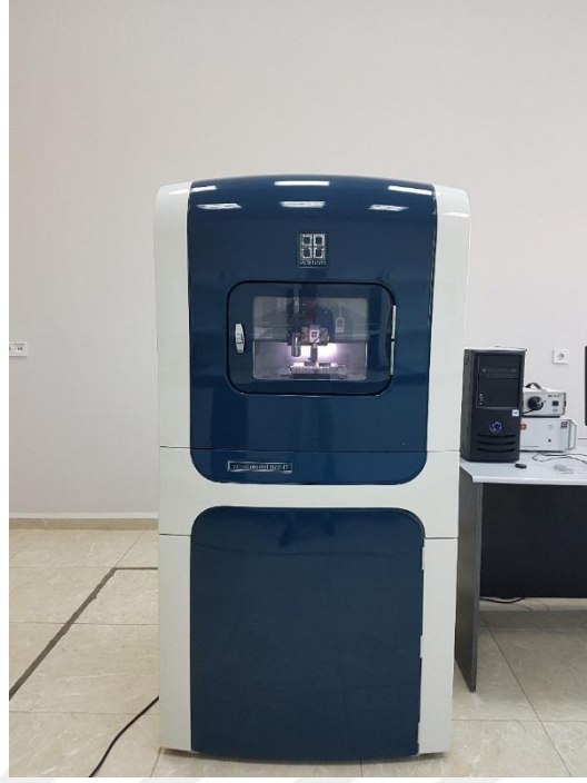
Şekil 2.8. Mustafa Kemal Üniversitesi Merkez Araştırma Laboratuvarı'nda bulunan Nano İndenter cihazı
