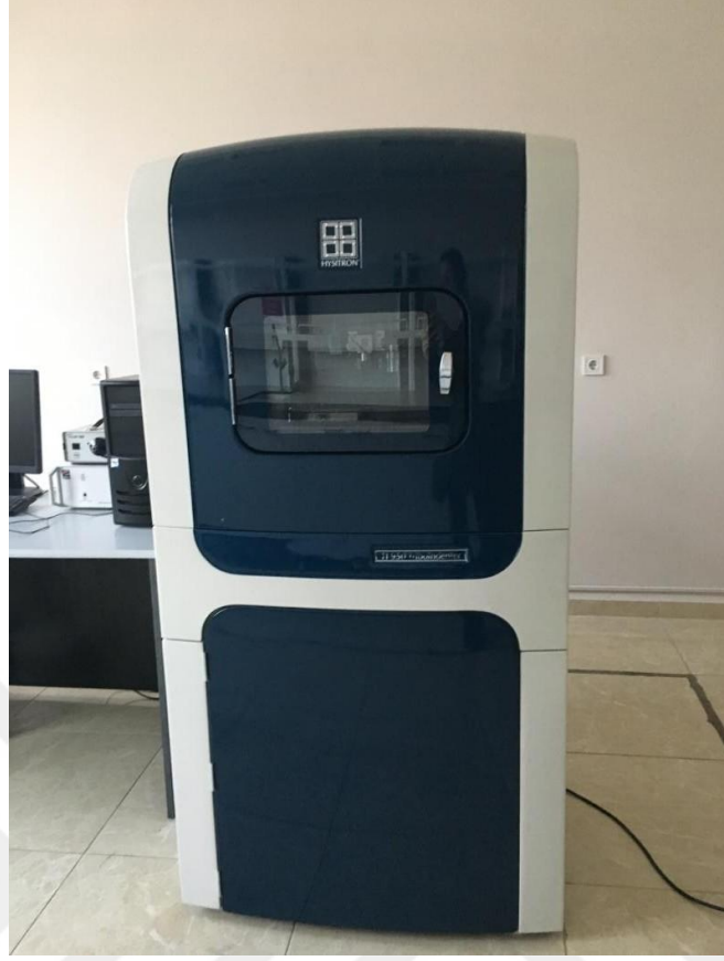
Şekil 3.23 Hysitron TI 950 TriboIndenter nanoindentasyon cihazı (Hysitron, ABD)
