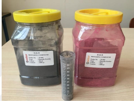
Şekil 3.16 Bakalit blokların yapımında kullanılan fenolik toz (Metkon, Türkiye)
