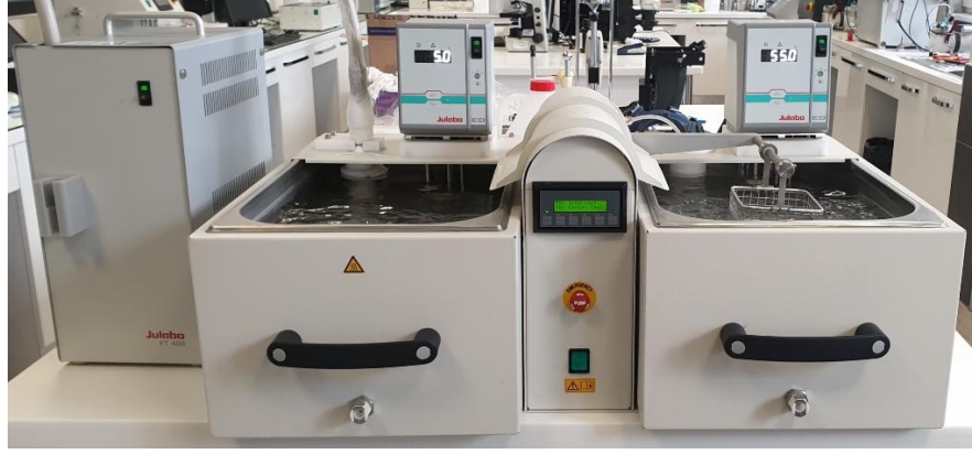
Şekil 3.9. Örneklerin termal siklusa tabi tutulması (Erciyes Üniversitesi Diş Hekimliği Fakültesi Araştırma Laboratuvarı)
