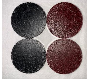
Şekil 3.20. Hazırlanan bakalit kalıp örnekleri
