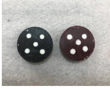
Şekil 3.23. Bakalit kalıplara yerleştirilmiş materyal örnekleri
