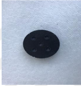
Şekil 3.21. Oyuk açılmış bakalit kalıp örneği
