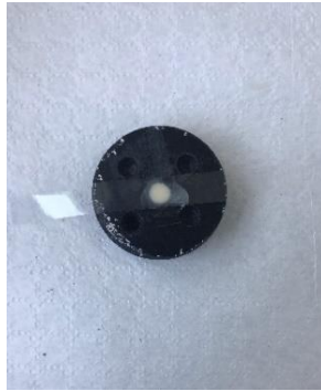
Şekil 3.22. Bakalit kalıplara materyallerin yerleştirilmesi
