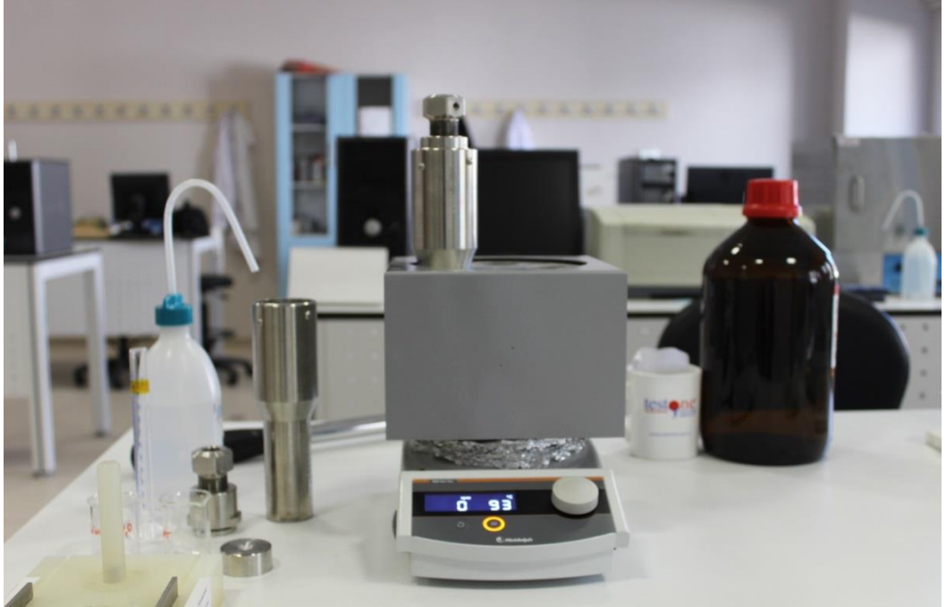
Şekil 3.9. ZnO nanoçubukların oluşturulduğu hidrotermal düzeneği
