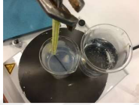
Şekil 3.20. Kimyasal banyo ile gümüş kaplam işlemi
