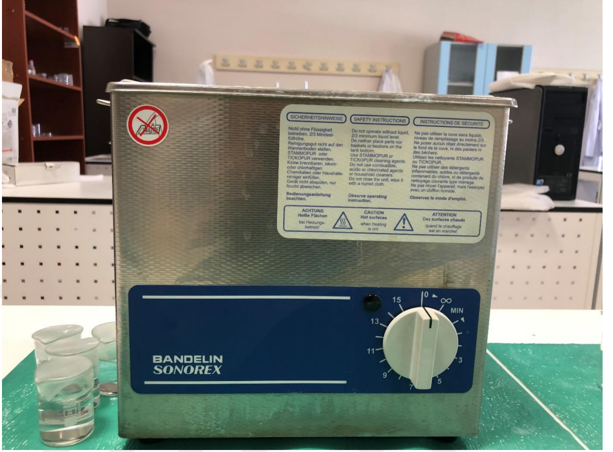
Şekil 3.2 Temizleme işleminde kullanılan ultrasonic banyo.
