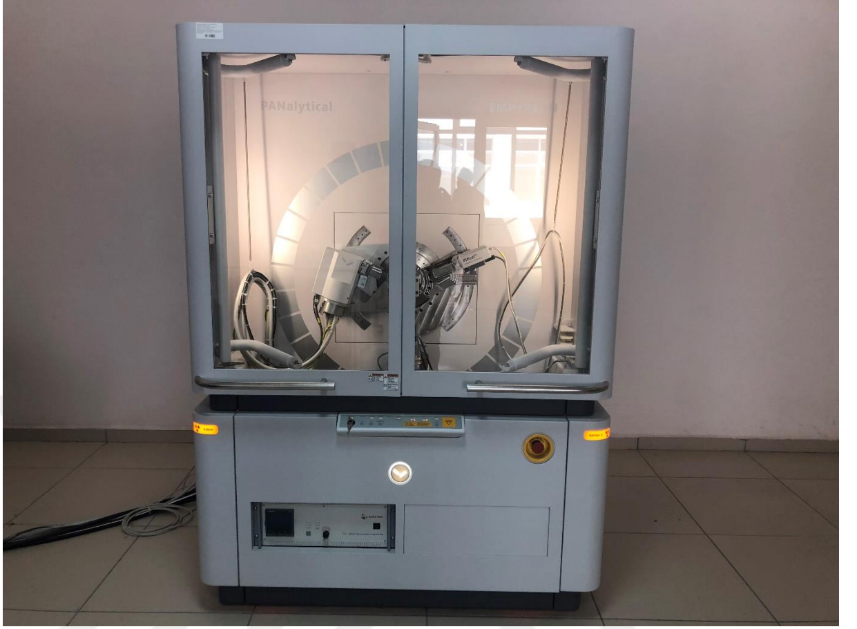
Şekil 3.7 Kristal yapının tayin edildiği XRD difraktometresi.
