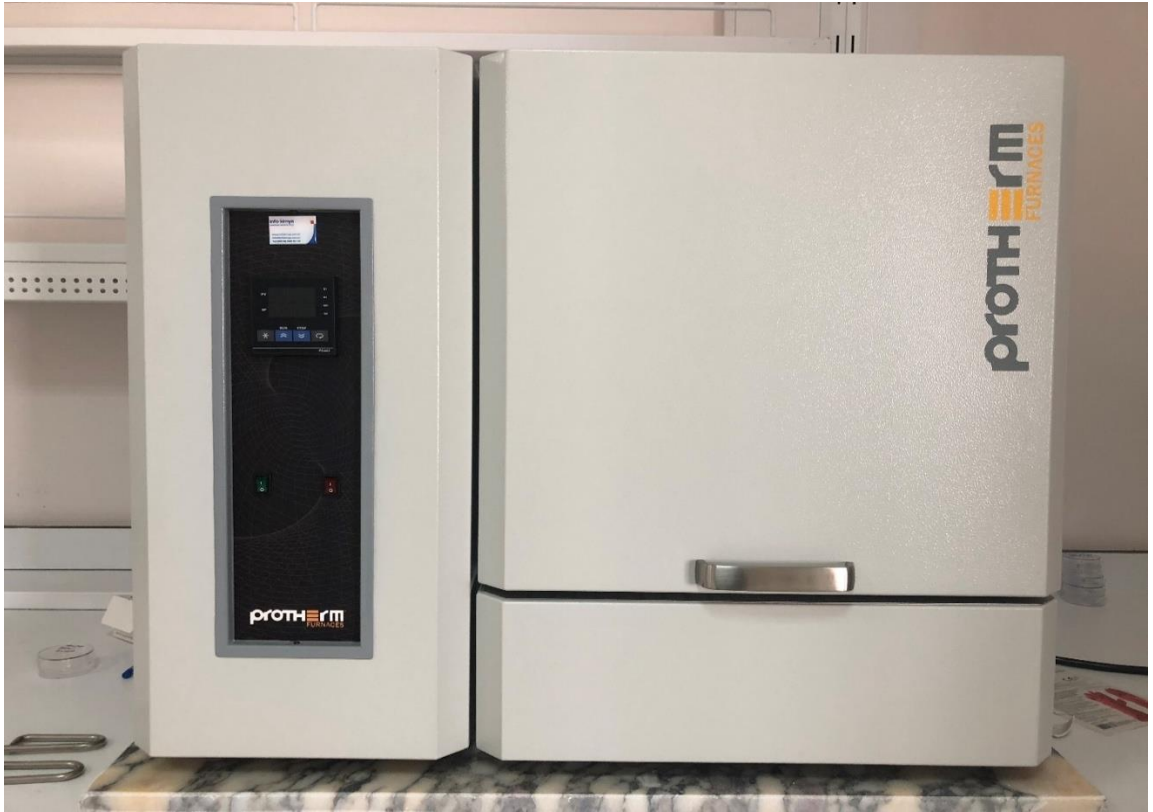
Şekil 3.4 Tavlama işleminin yapıldığı kül fırını.
