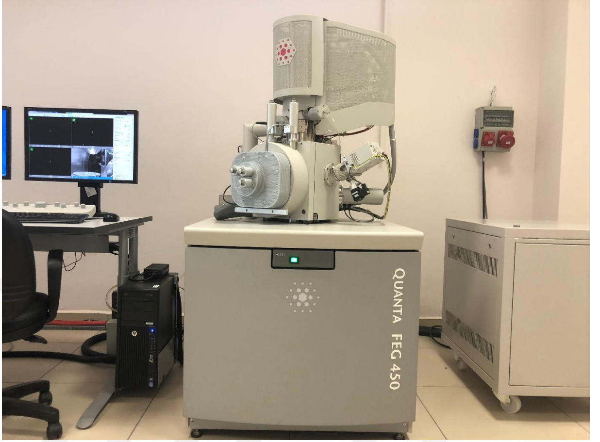
Şekil 3.8 Yüzey morfolojisinin karakterize edildiği SEM cihazı.
