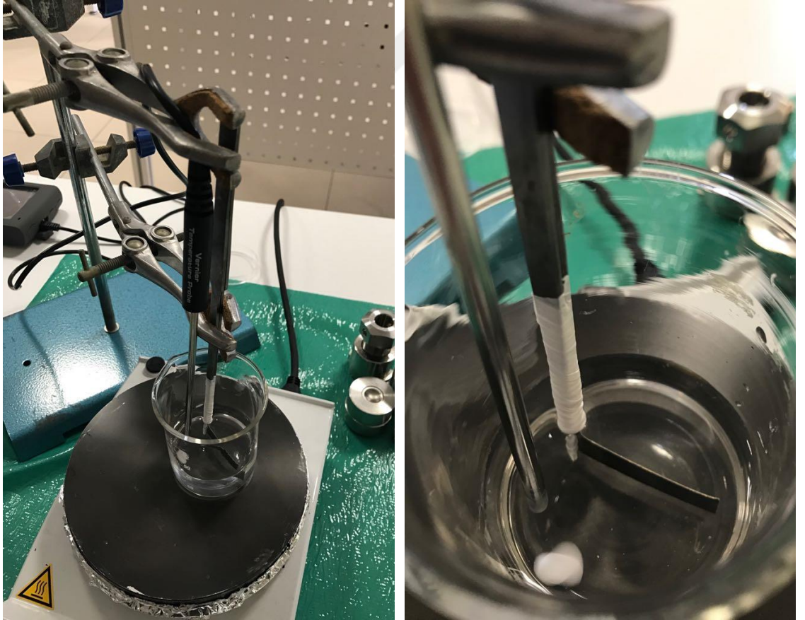
Şekil 3.5 ZnO nanoparçacıkların büyüdüğü kimyasal banyo biriktirme deney düzeneği.
