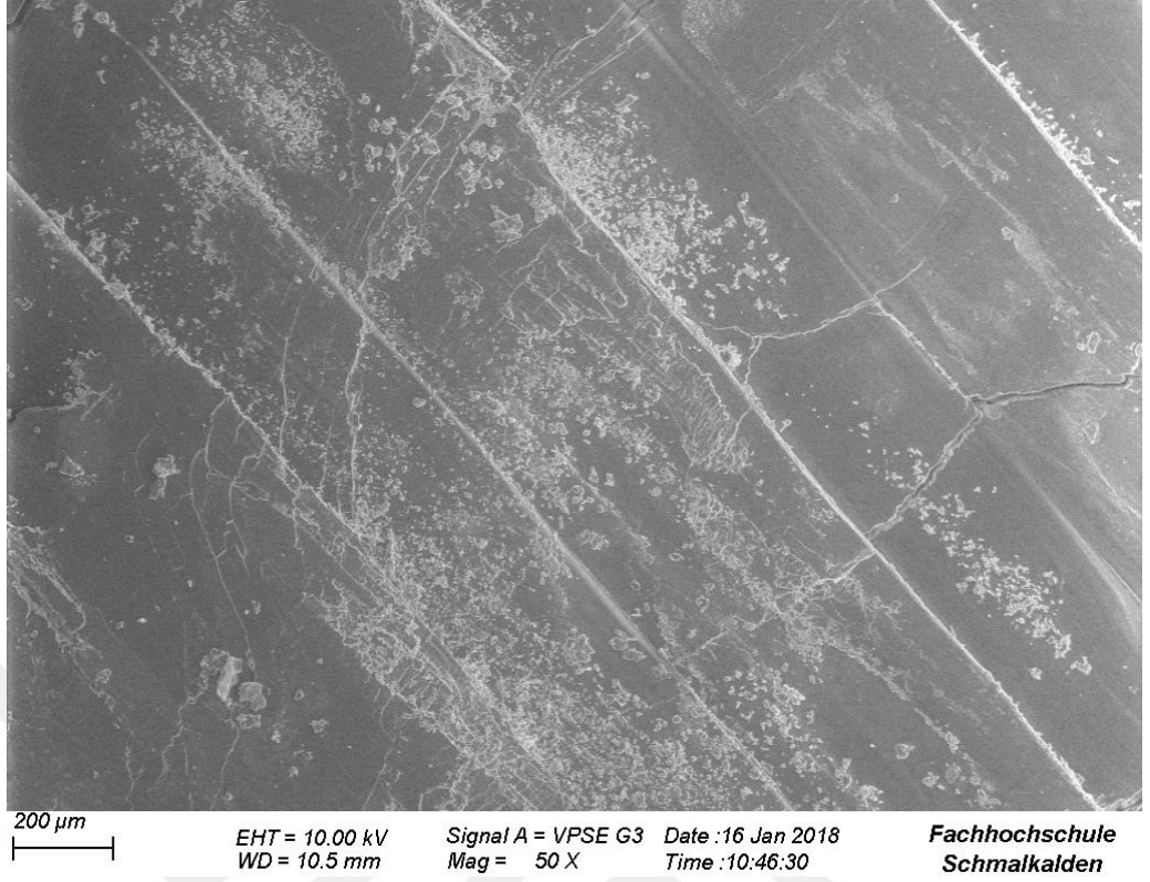
Şekil 4.7. %5 biyokarbon takviyeli PLA'nın aşınma yüzeyi SEM görüntüsü
