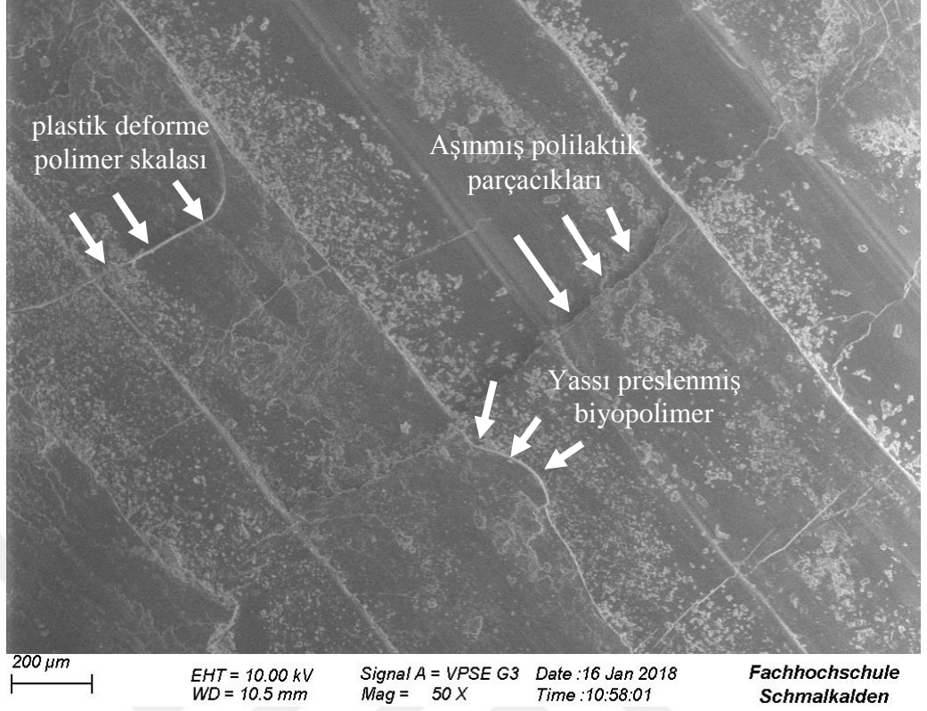
Şekil 4.6. Biyokarbon takviyesiz PLA'nın aşınma yüzeyi SEM görüntüsü
