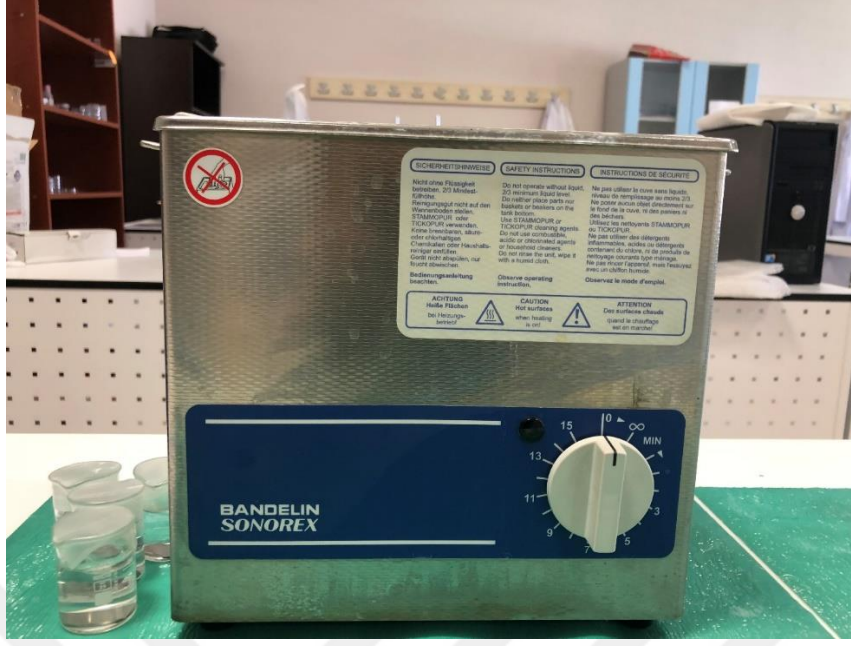
Şekil 3. 2. Temizleme işleminde kullanılan ultrasonik banyo
