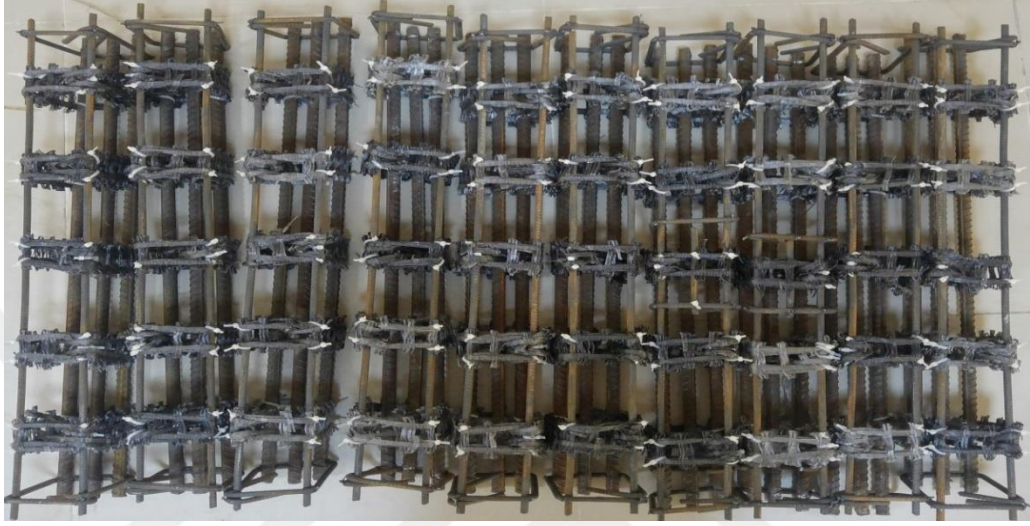
Şekil 4. 12. Hazırlanan geogrid etriyeli kirişler
