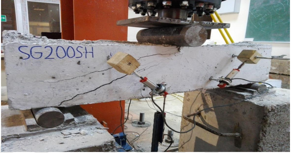
Şekil 5.16. Deney sonrası SG200SH kiriş numunesi
