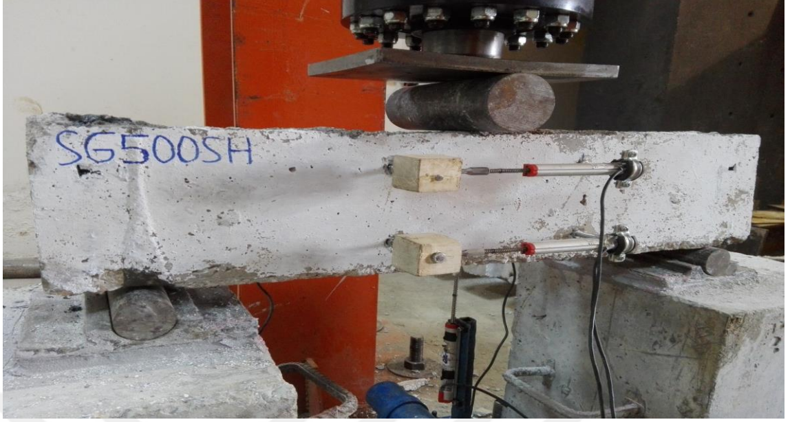
Şekil 5.31. Deney öncesi SG500SH kiriş numunesi
