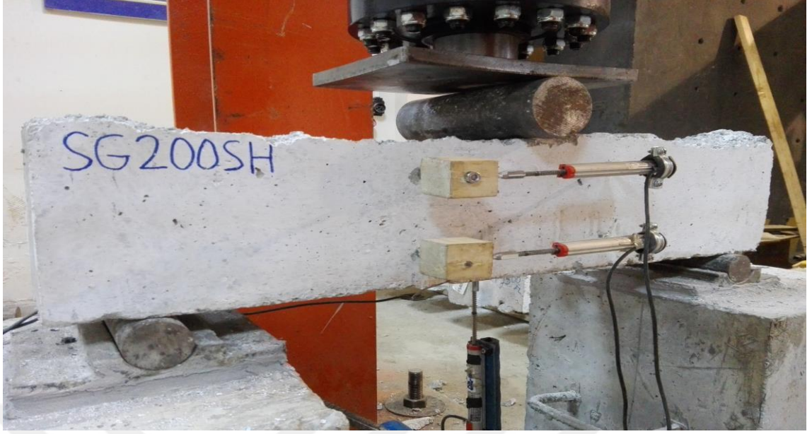
Şekil 5.15. Deney öncesi SG200SH kiriş numunesi
