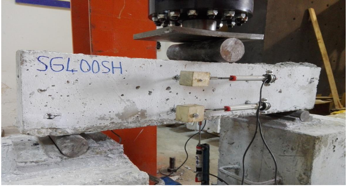
Şekil 5.27. Deney öncesi SG400SH kiriş numunesi
