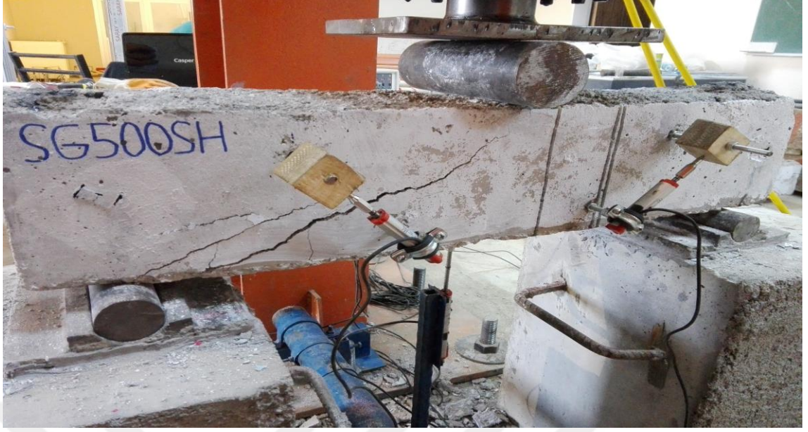
Şekil 5.32. Deney sonrası SG500SH kiriş numunesi
