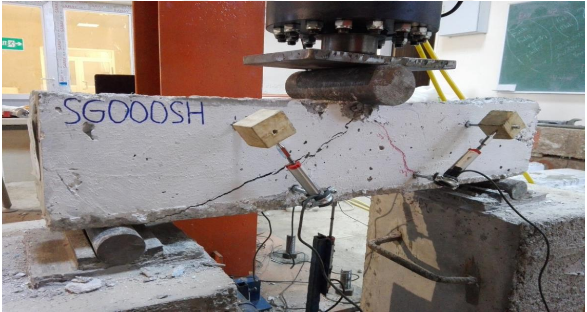
Şekil 5.4. Deney sonrası sg000sh kiriş numunesi
