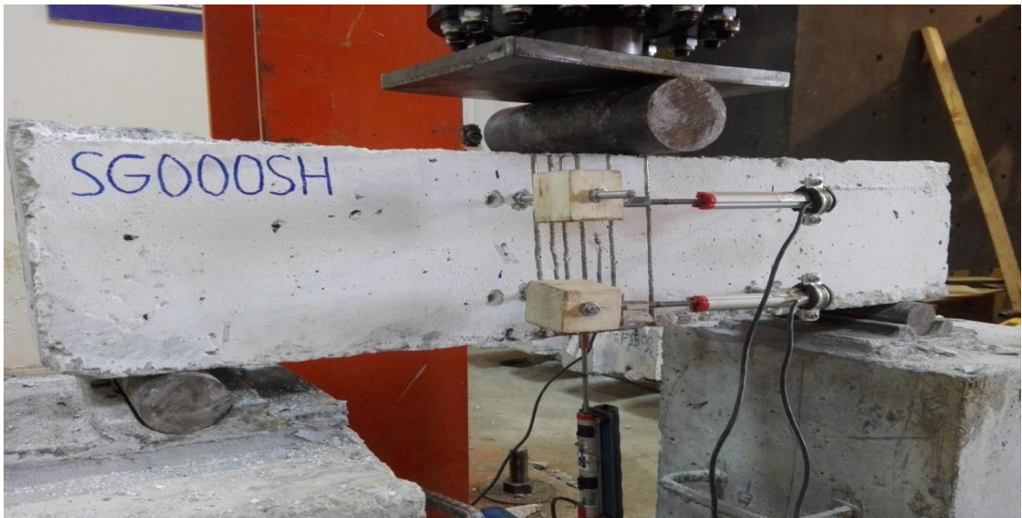
Şekil 5.3. Deney öncesi SG000SH kiriş numunesi
