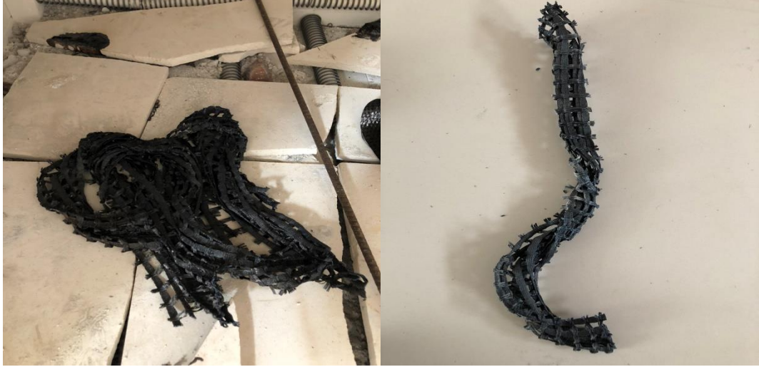
Şekil 6. 1. Korumasız halde yüksek sıcaklıklara maruz bırakılan geogrid numuneler
