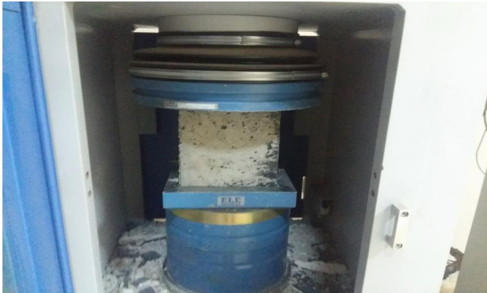
Şekil 4.2. Beton dayanım tespiti
