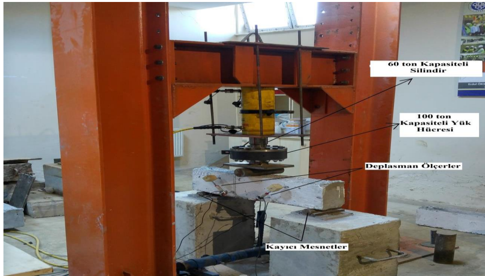
Şekil 4.13. Kiriş numuneleri için deney düzeneđi
