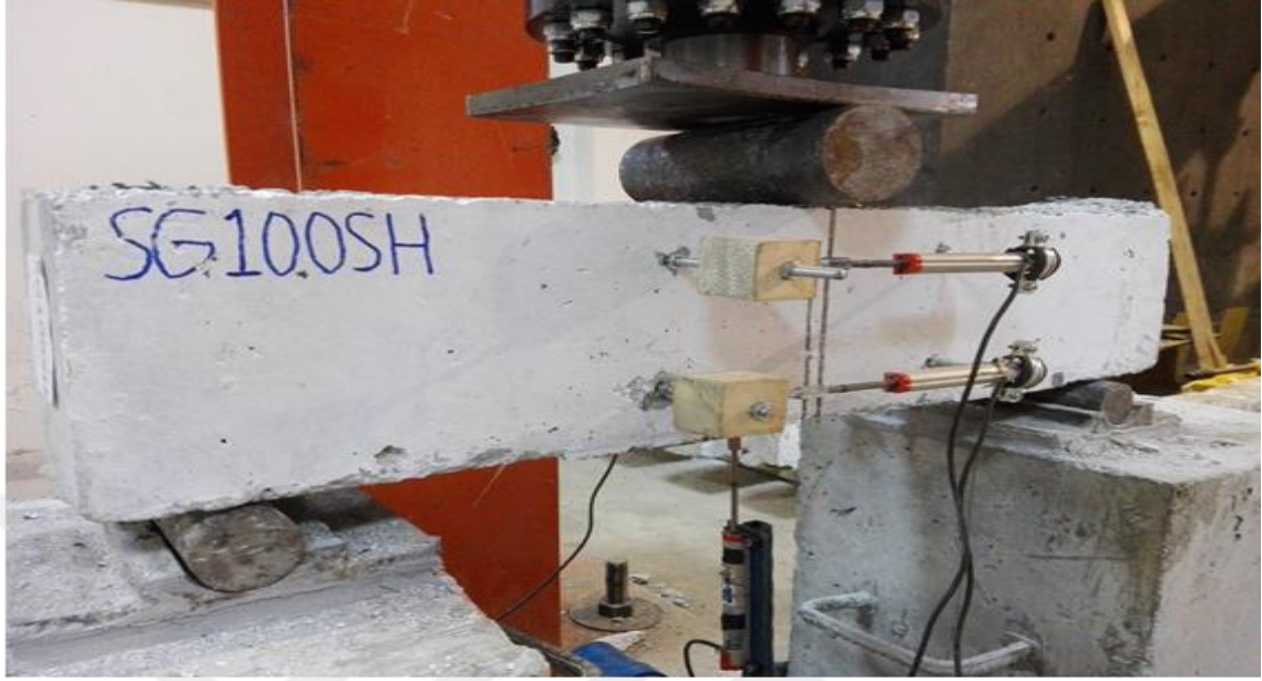
Şekil 5.7. Deney öncesi SG100SH kiriş numunesi
