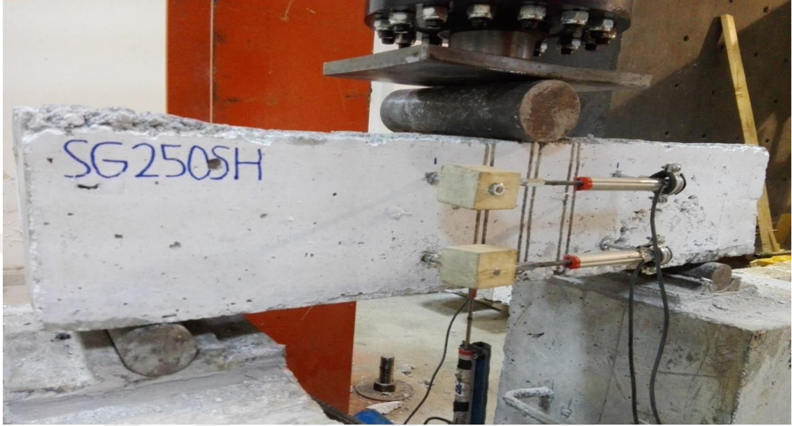
Şekil 5.19. Deney öncesi SG250SH kiriş numunesi
