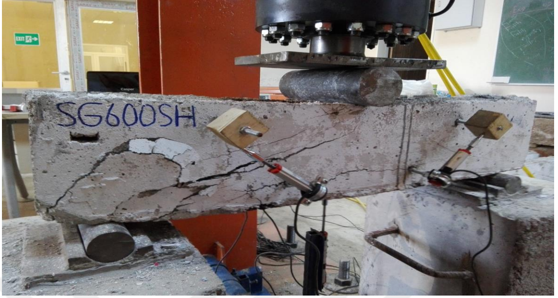
Şekil 5.36 . Deney sonrası SG600SH kiriş numunesi
