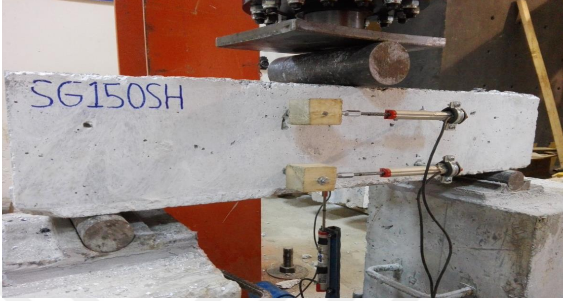
Şekil 5.11. Deney öncesi SG150SH kiriş numunesi
