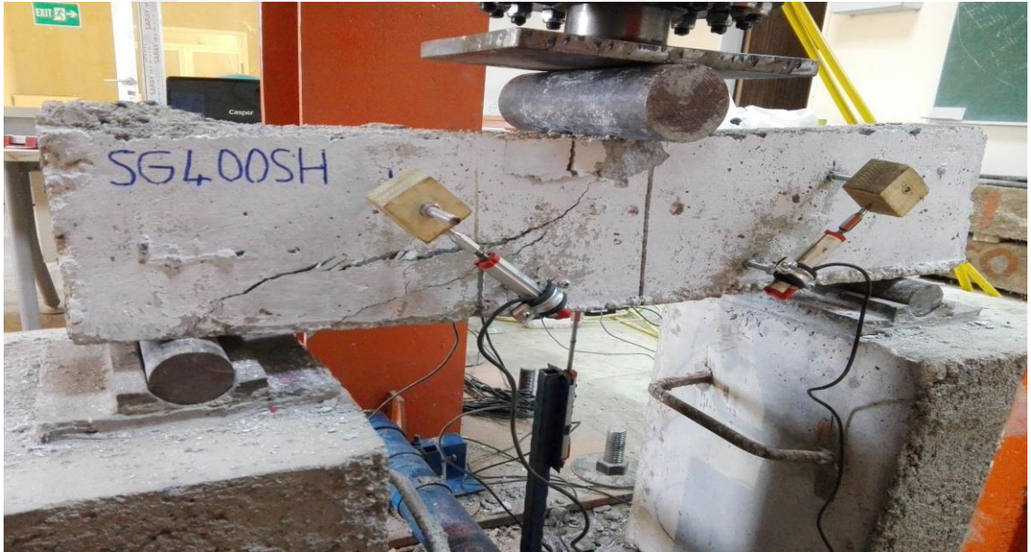
Şekil 5.28. Deney sonrası SG400SH kiriş numunesi
