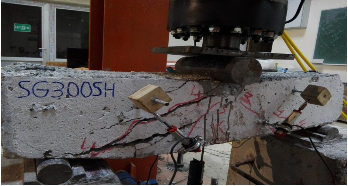
Şekil 5.24. Deney sonrası SG300SH kiriş numunesi
