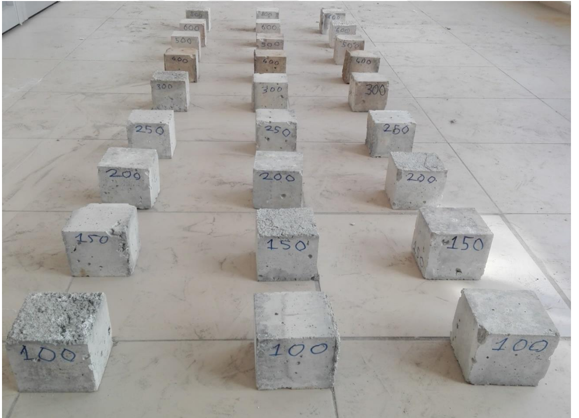
Şekil 5.1. Her sıcaklık grubu için küp basınç numuneleri.
