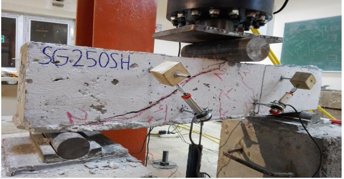
Şekil 5.20. Deney sonrası SG250SH kiriş numunesi
