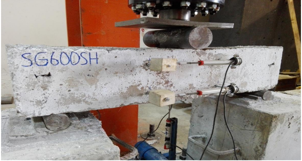
Şekil 5.35. Deney öncesi SG600SH kiriş numunesi
