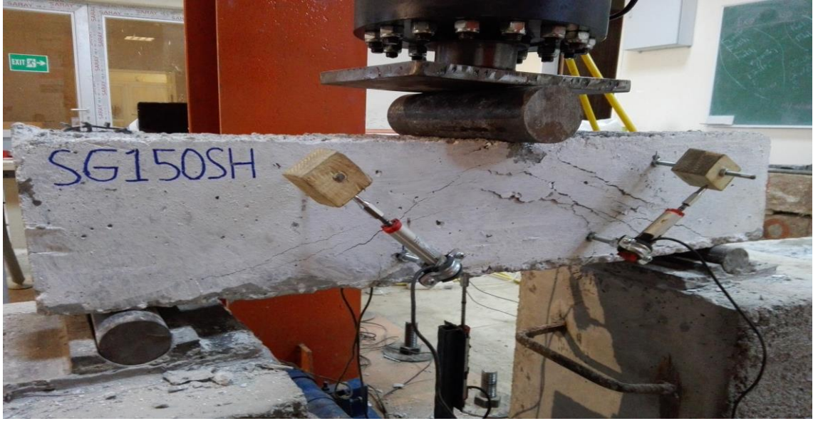
Şekil 5.12. Deney sonrası SG150SH kiriş numunesi
