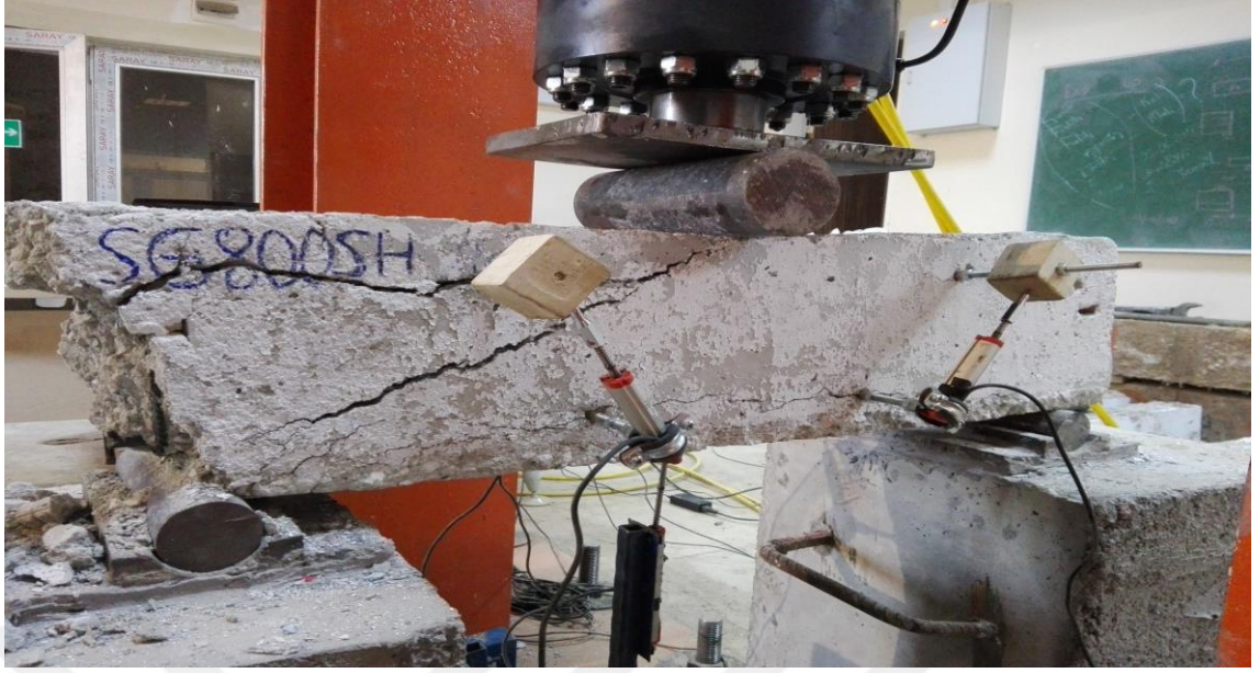
Şekil 5.40. Deney sonrası SG800SH kiriş numunesi
