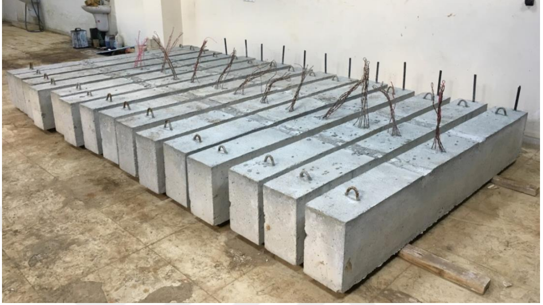
Şekil 4.12. Kalıptan Çıkarılan Betonarme Kirişler
