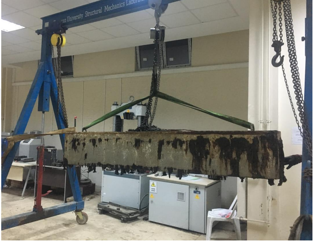
Şekil 5.2. Kirişlerin Havuzdan Çıkarılması.
