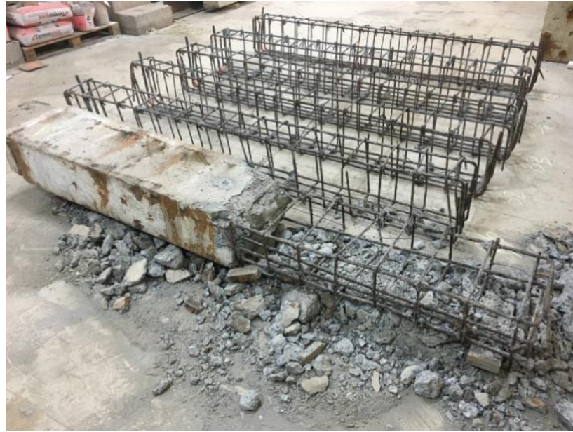
Ŗekil 5.5. Betondan ıkarılan Donatılar.
