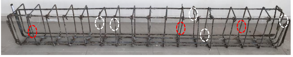
Şekil 5.17. Paslanmış B7 Kirişi Donatı Kafesi
