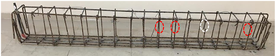
Şekil 5.14. Paslanmış B4 Kirişi Donatı Kafesi
