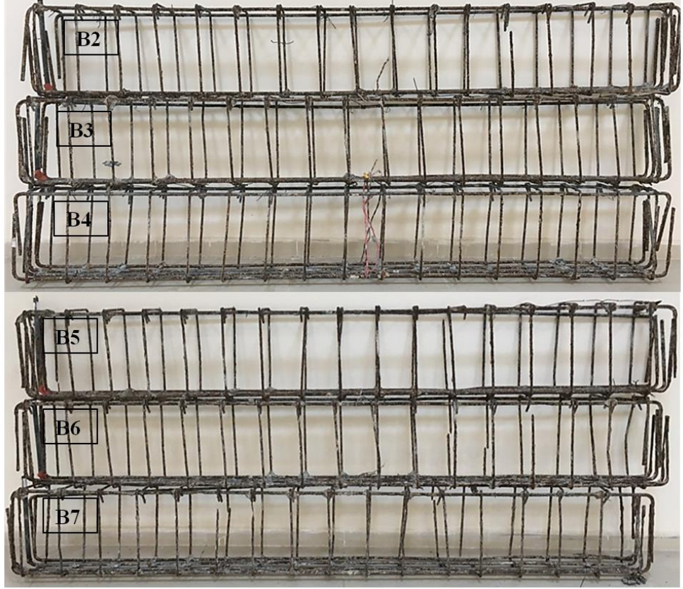
Şekil 5.6. Betonarme kirişlerin donatı kafesleri (B2-B3-B4-B5-B6-B7 Kirişleri)
