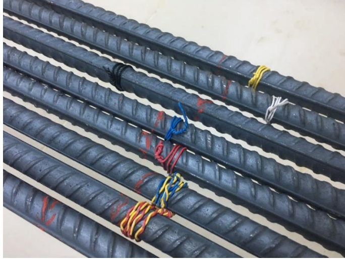
Şekil 3.4. Bakır kabloların boyuna donatılara bağlanması.
