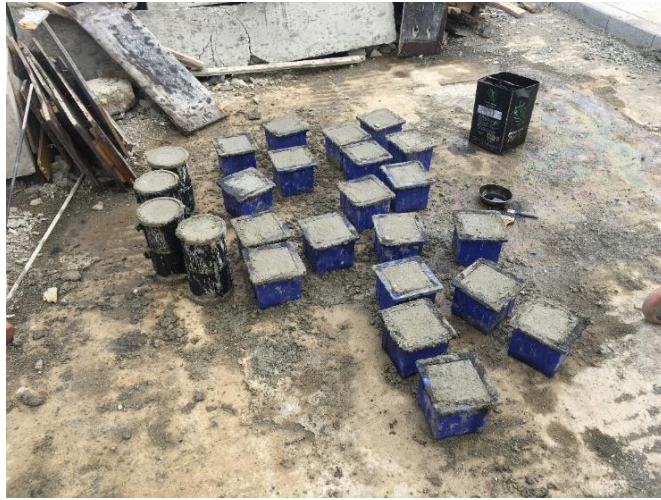
Şekil 3.11. Küp ve silindir numune alımı.
