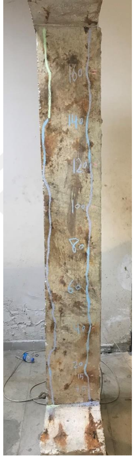
Şekil 3.22. C19 betonarme kolonun çatlak haritası.
