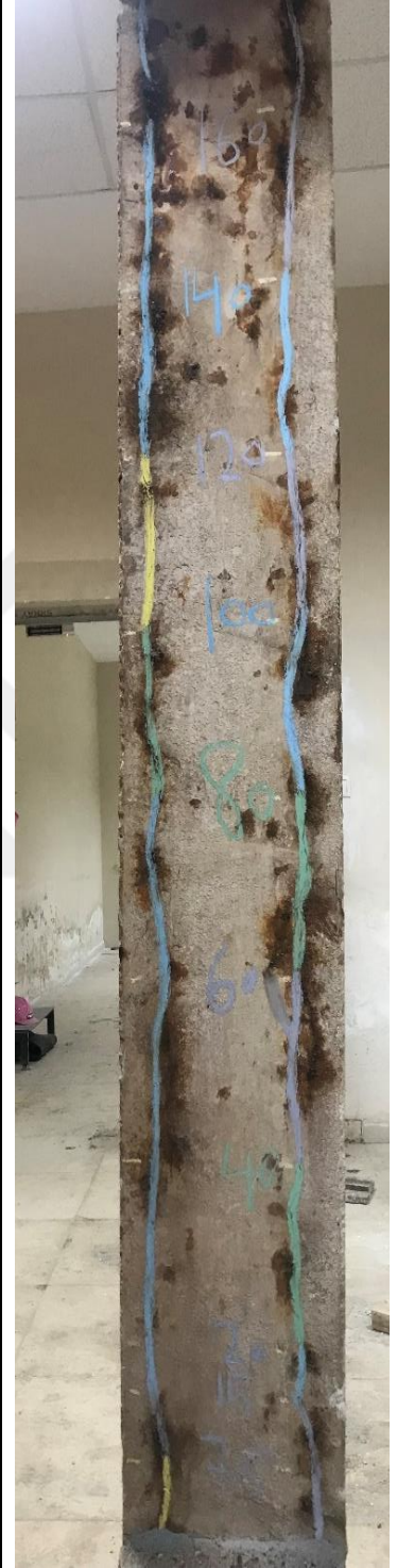
Şekil 3.23. C20 betonarme kolonun çatlak haritası.
