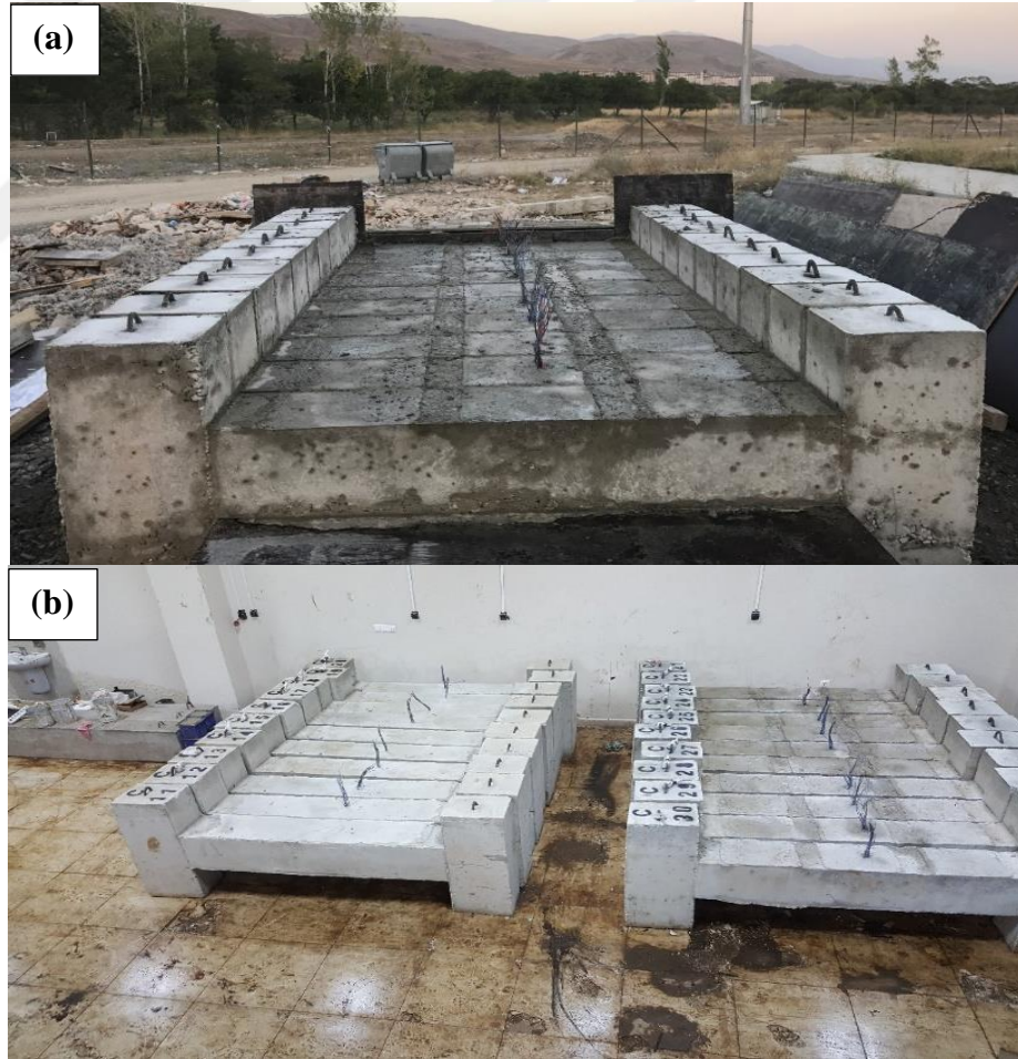
Şekil 3.12. Kalıptan çıkartılan betonarme kolonları: (a) C8, (b) C20 ve C30.
