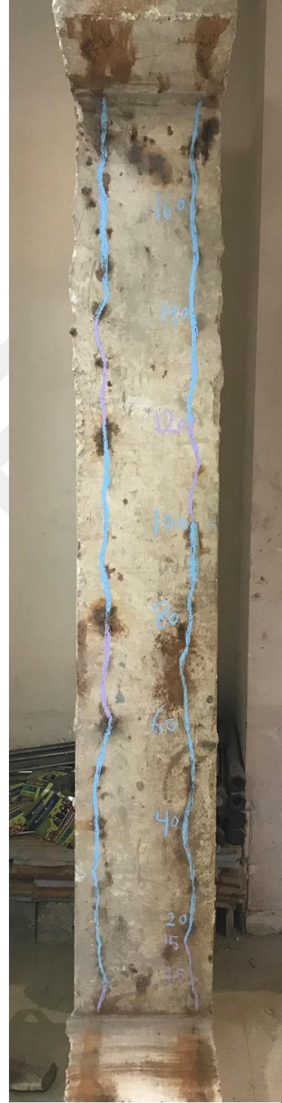
Şekil 3.24. C24 betonarme kolonun çatlak haritası.
