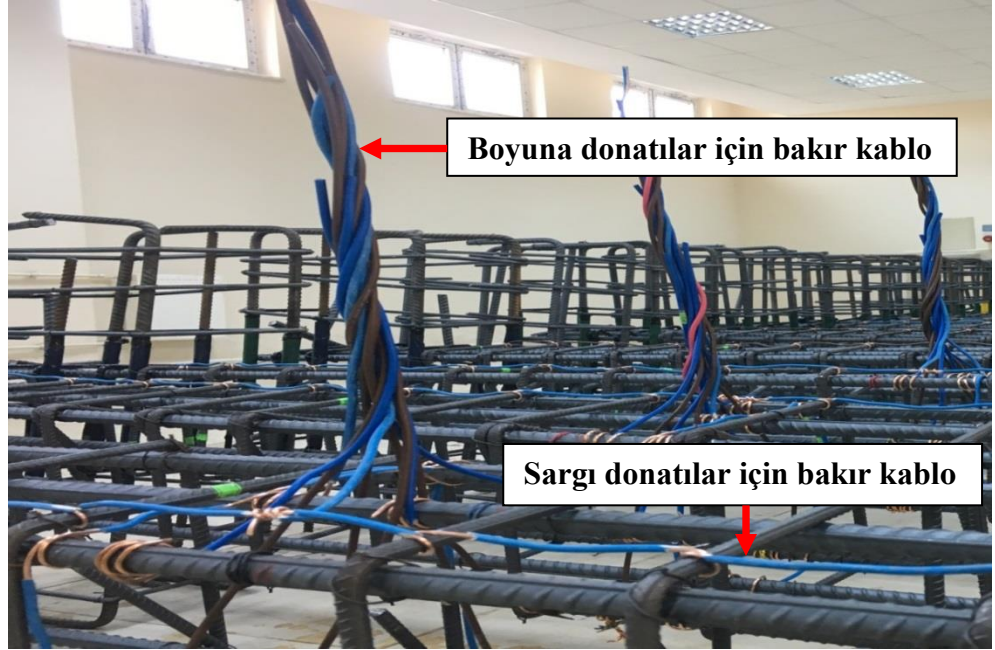
Şekil 4.11. Pozitif yüklemeyi sağlayacak olan bakır kabloların boyuna donatılara ve kolon boyunca sargı donatılarına bağlanması.
