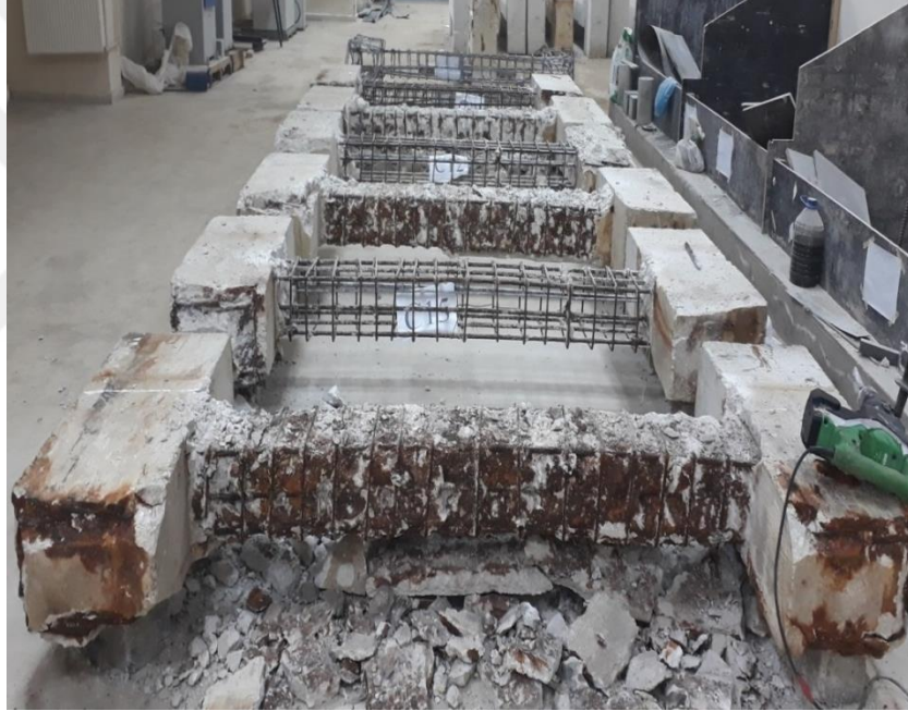
Şekil 5.1. Yükleme deneyleri sonrası betonarme kolonlarının kırılması.
