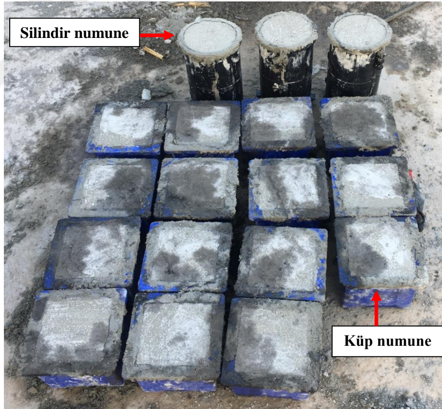
Şekil 4.16. Küp ve silindir numune alımı.
