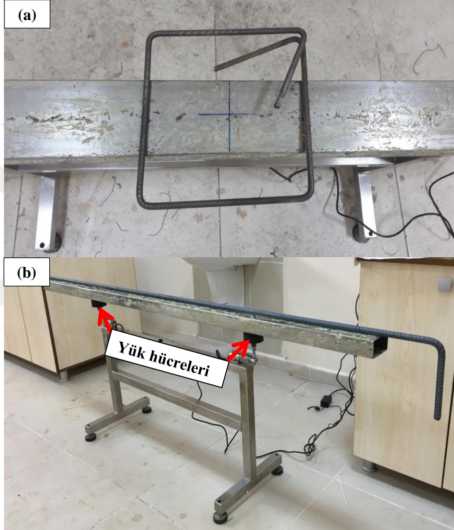
Şekil 4.5. Betonarme donatıların tartılma işlemi: (a) enine sargı donatılarının tartılması, (b) boyuna donatıların tartılması.
