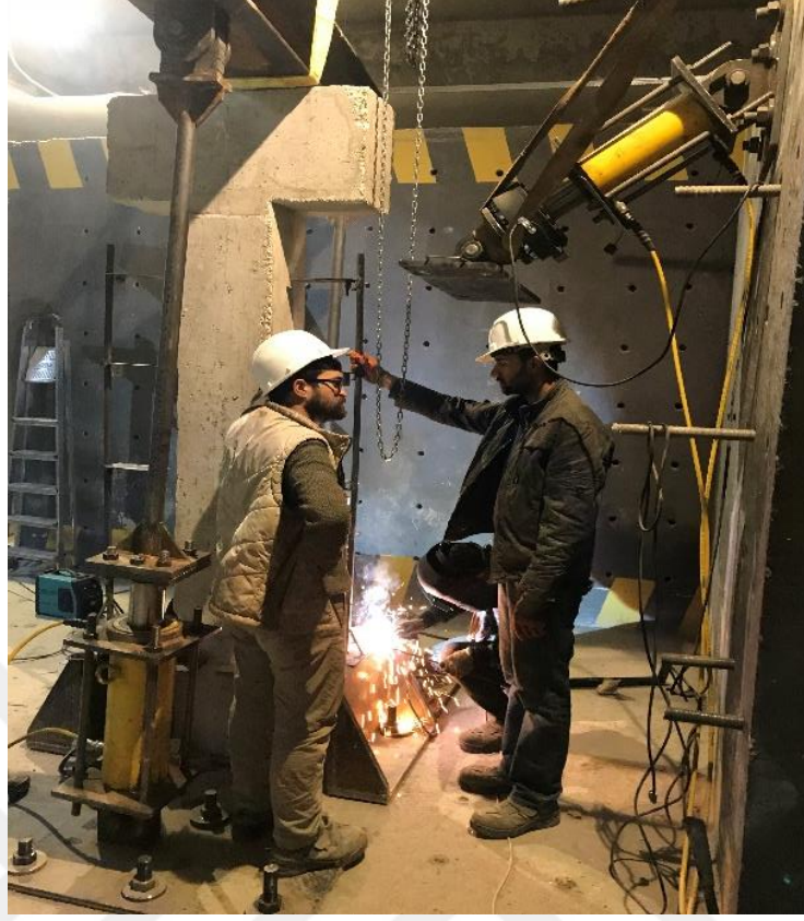
Şekil 4.26. Deney düzeneğın kaynak işleri.
