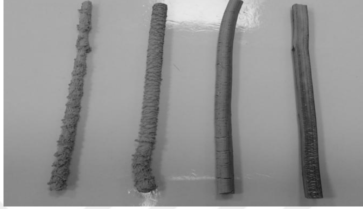
Şekil 4.22. Tek vidalı ekstrüderden alınan bozuk yüzeyli numuneler
