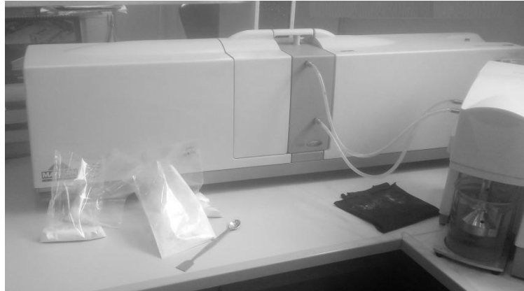
Şekil 4.9. Tane boyutu dağılımı analizinde kullanılan Malvern Mastersizer 2000 cihazı
