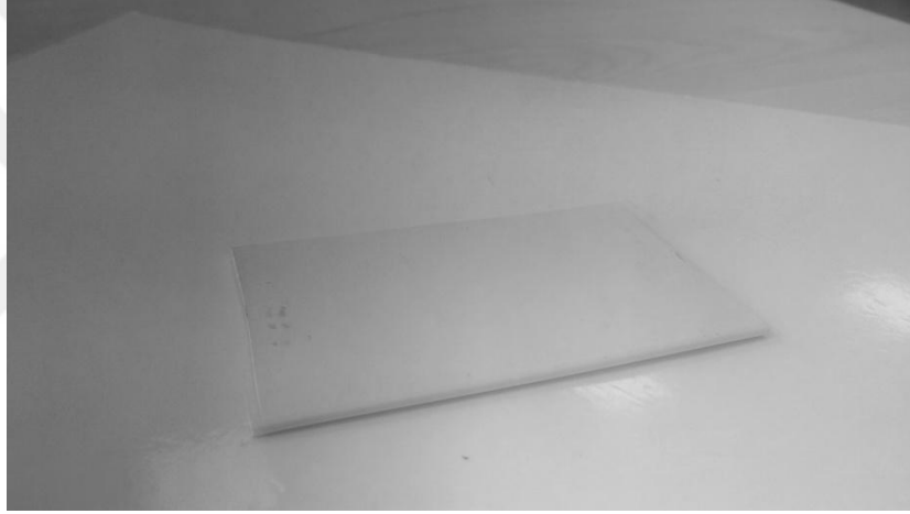
Şekil 5.14. %5 MFP içeren numunedeki boyutsal çarpılma
