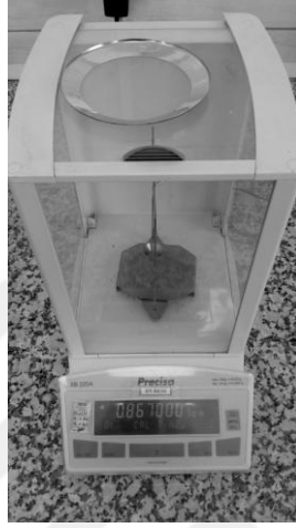
Şekil 4.10. Yoğunluk tayininde kullanılan Presica XB 220 A yoğunluk kiti
