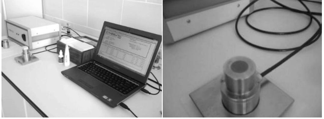
Şekil 4.16. Termal iletkenlik tespitinde kullanılan C-THERM cihazı
