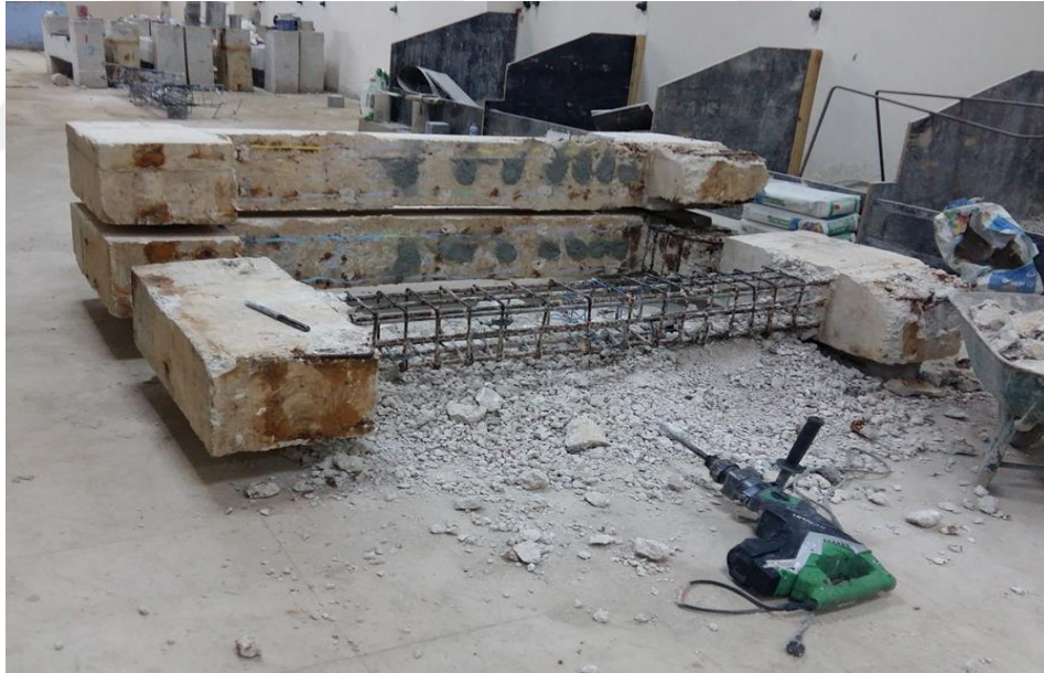
Şekil 5.1. Betonarme kolonların yükleme deneylerinden sonra kırılması işleri.
