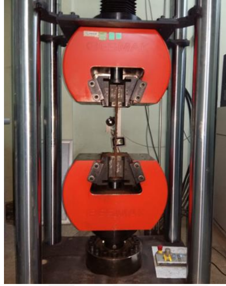
Şekil 4.2. Betonarme donatılarına uygulanan donatı çekme deneyi.
