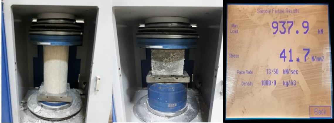
Şekil 4.1. Silindir ve küp numunelerin beton basınç deneyleri.
