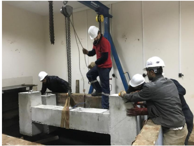
Őekil 4.30. Kolon numunelerin tam lekli paslandırma havuzuna tařınması.
