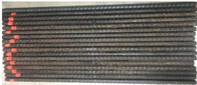
Şekil 5.6. Çekme deneyi uygulanan betonarme kupon donatıları.
