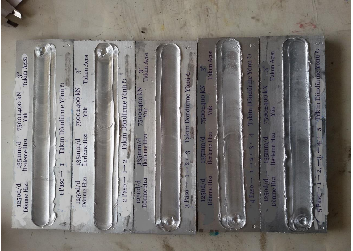
Şekil 3. 3. Farklı pasolarda SKP uygulanmış 200 mm uzunluğunda ve 8 mm kalınlığında Al5083 numuneler
