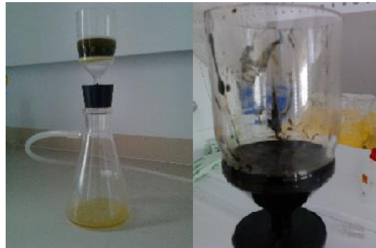
Şekil 3.2. Vakum altında süzülmesi ve klorofillerin ayrılması
