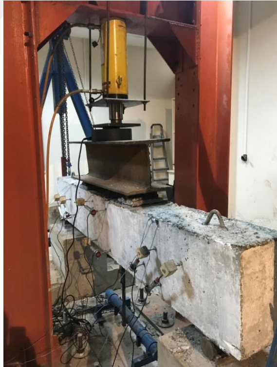
Şekil 3.24. SH-G60 numunesinin yükleme ve ölçüm düzeneği
