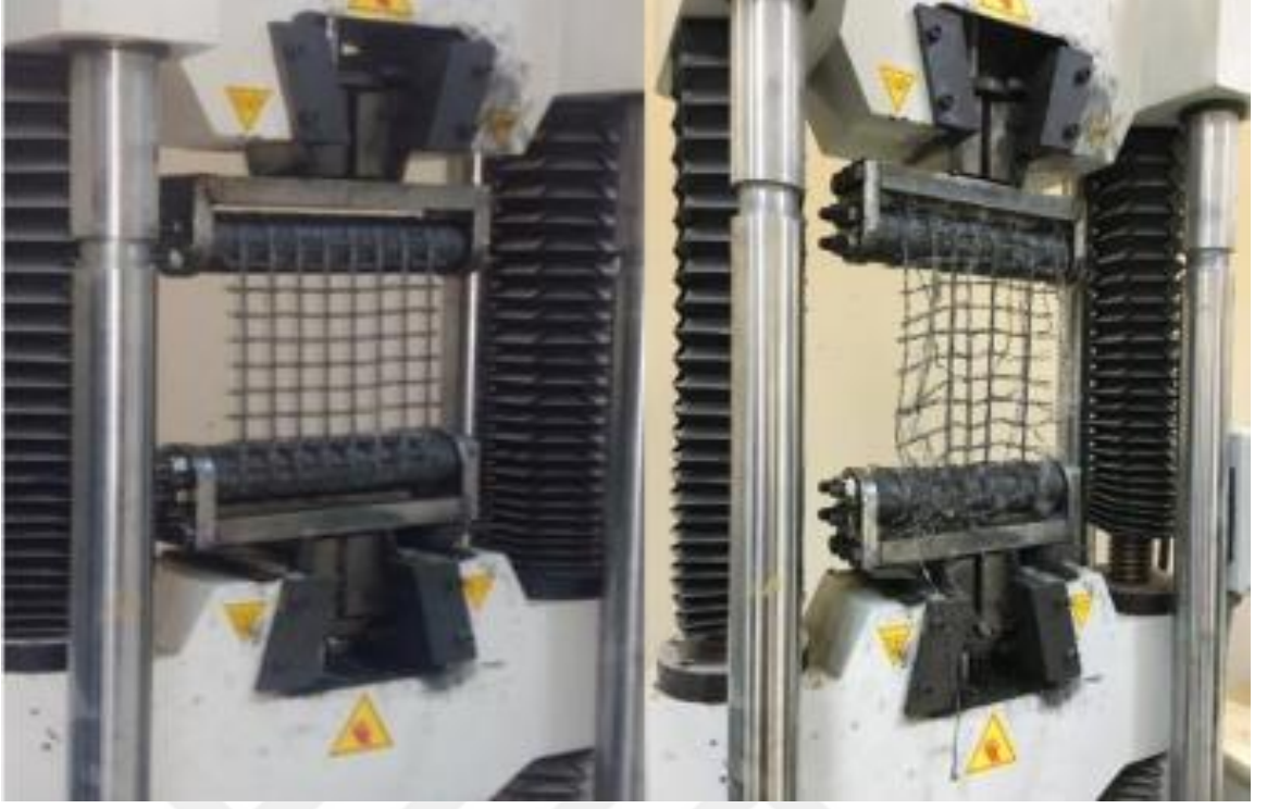
Şekil 3.8. ASTM D4595 – 11’ e göre gerçekleştirilen geogrid çekme deneyi
