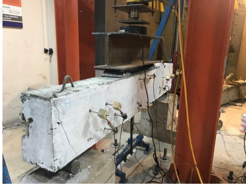
Şekil 3.22. SH-G30 numunesinin yükleme ve ölçüm düzeneği
