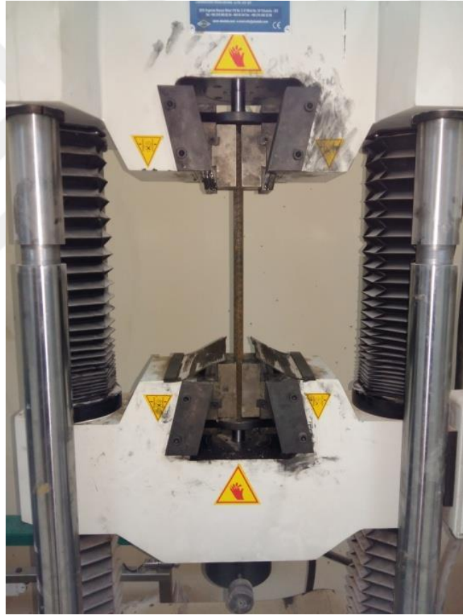
Şekil 3.3. Çelik donatı çekme deneyi
