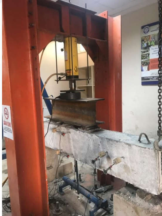
Şekil 3.26. SH-S90 numunesinin yükleme ve ölçüm düzeneği
