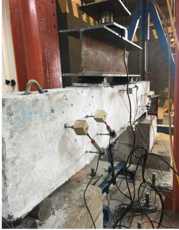
Şekil 3.23. SH-G45 numunesinin yükleme ve ölçüm düzeneği
