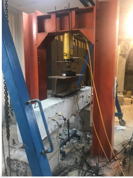
Şekil 3.21. SH-N numunesinin yükleme ve ölçüm düzeneği
