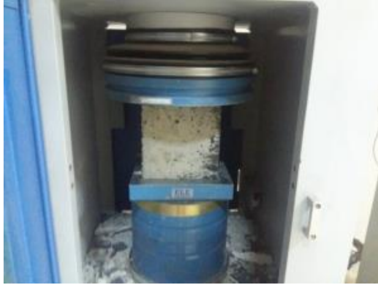
Şekil 3.2. Beton dayanımının tespit işlemi
