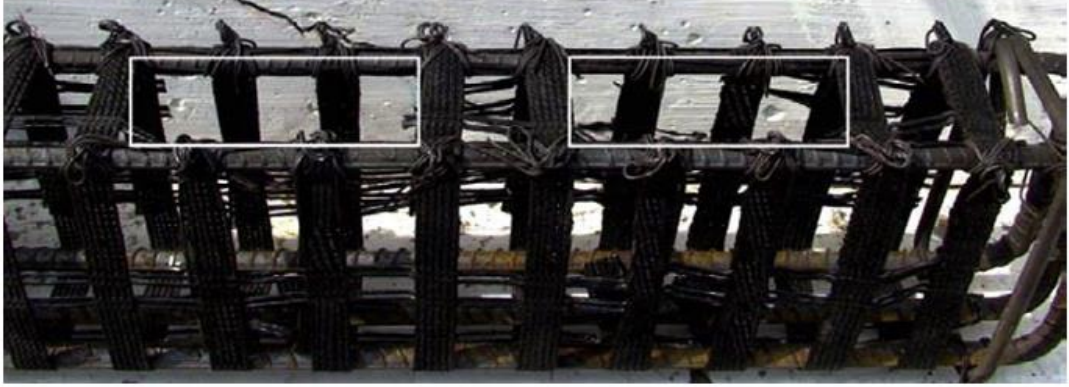
Şekil 1.2. Geogridin enine donatı olarak uygulanması (Chidambaram ve Agarwal, 2015)
