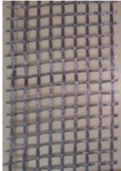
Şekil 3.7. Çekme deneyi için hazırlanmış geogrid numunesi
