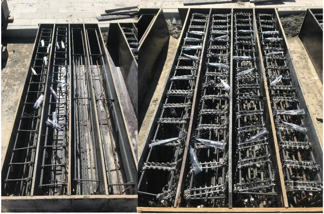
Şekil 3.1. Beton dökümüne hazır kiriş numuneleri
