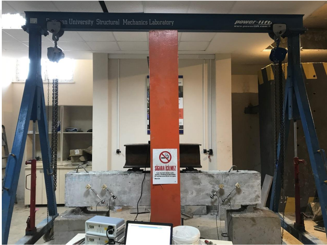
Şekil 3.20. Eğilme deneyi düzeneği
