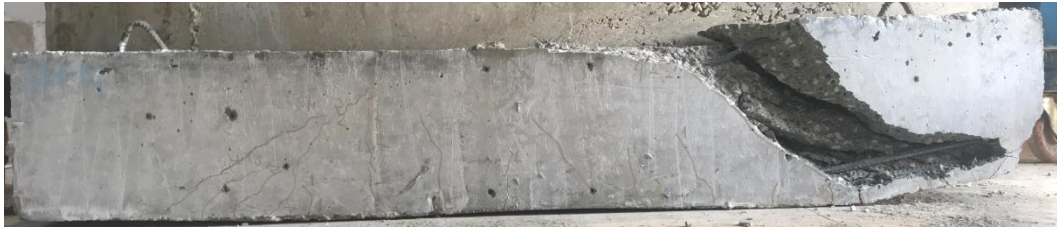
Şekil 4.1. SH-N numunesinin çatlak gelişimi
