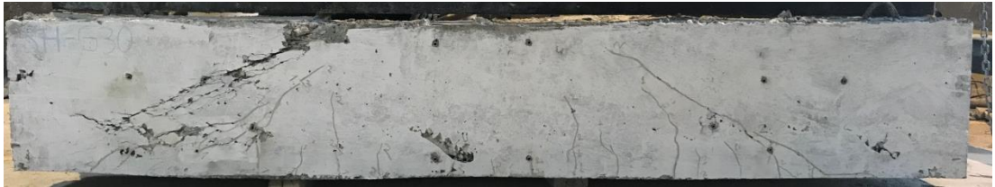
Şekil 4.3. SH-G30 numunesinin çatlak gelişimi
