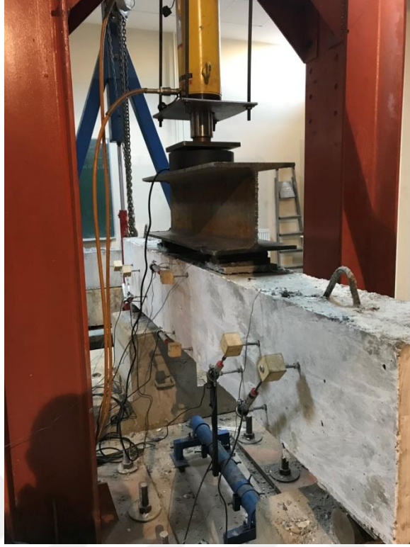
Şekil 3.25. SH-G90 numunesinin yükleme ve ölçüm düzeneği
