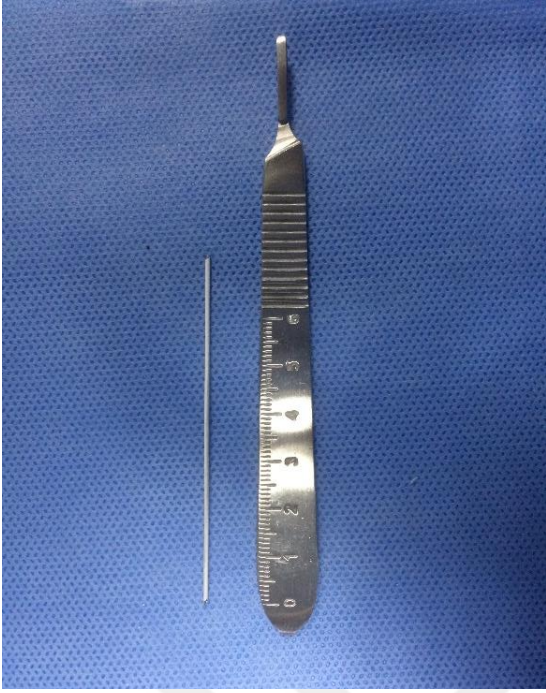
Şekil 3.5.3. Biyokompozit kaplama uygulanmış paslanmaz çelik K teli
