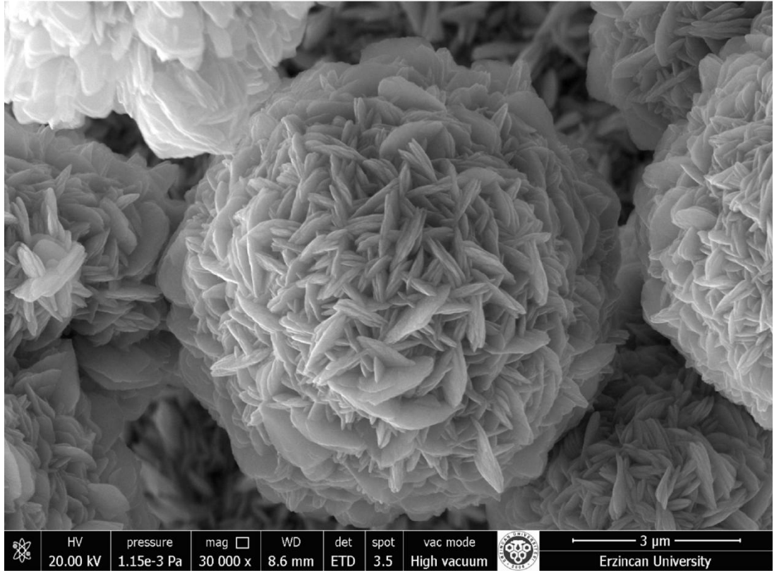
Şekil 4.8. 140 C sıcaklıkta ve 24 saat sentez süresinde elde edilen CuO filmlerin SEM görüntüleri
