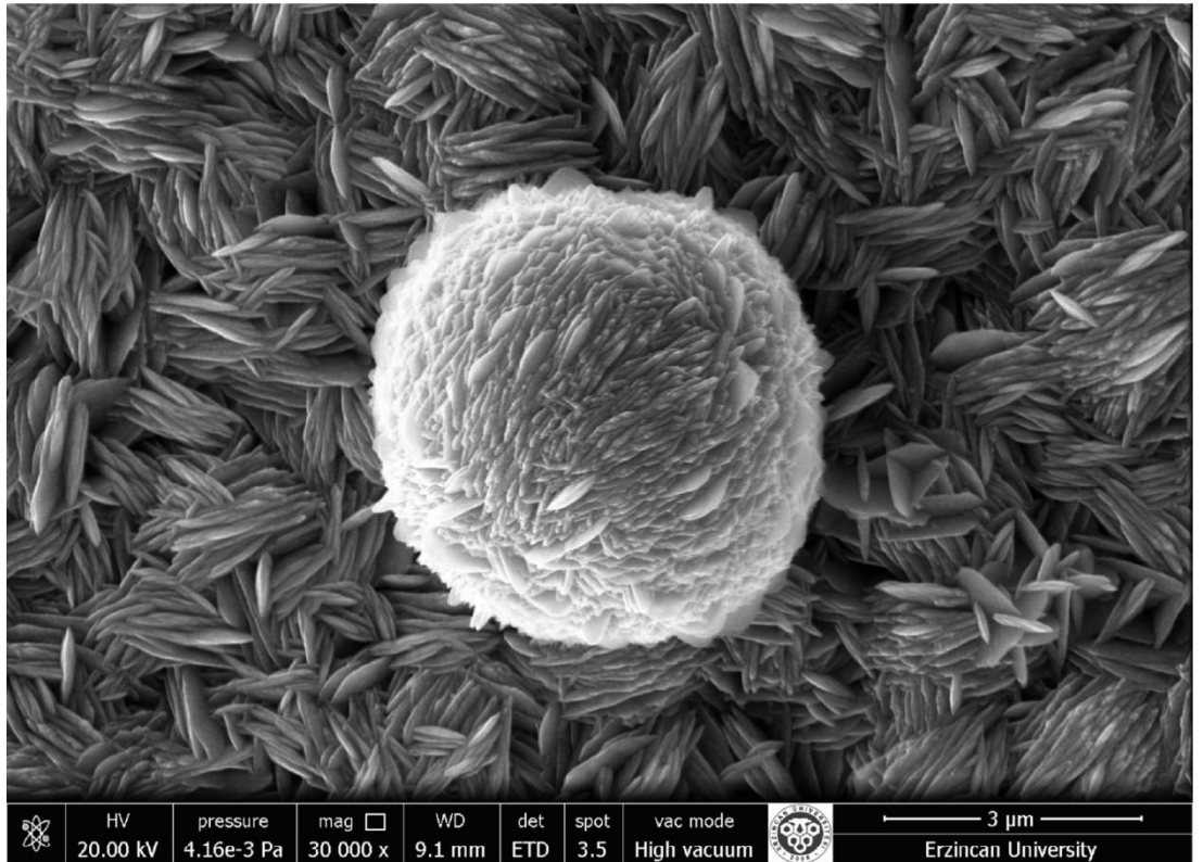
Şekil 4.7. 120 C sıcaklıkta ve 24 saat sentez süresinde elde edilen CuO filmlerin SEM görüntüleri
