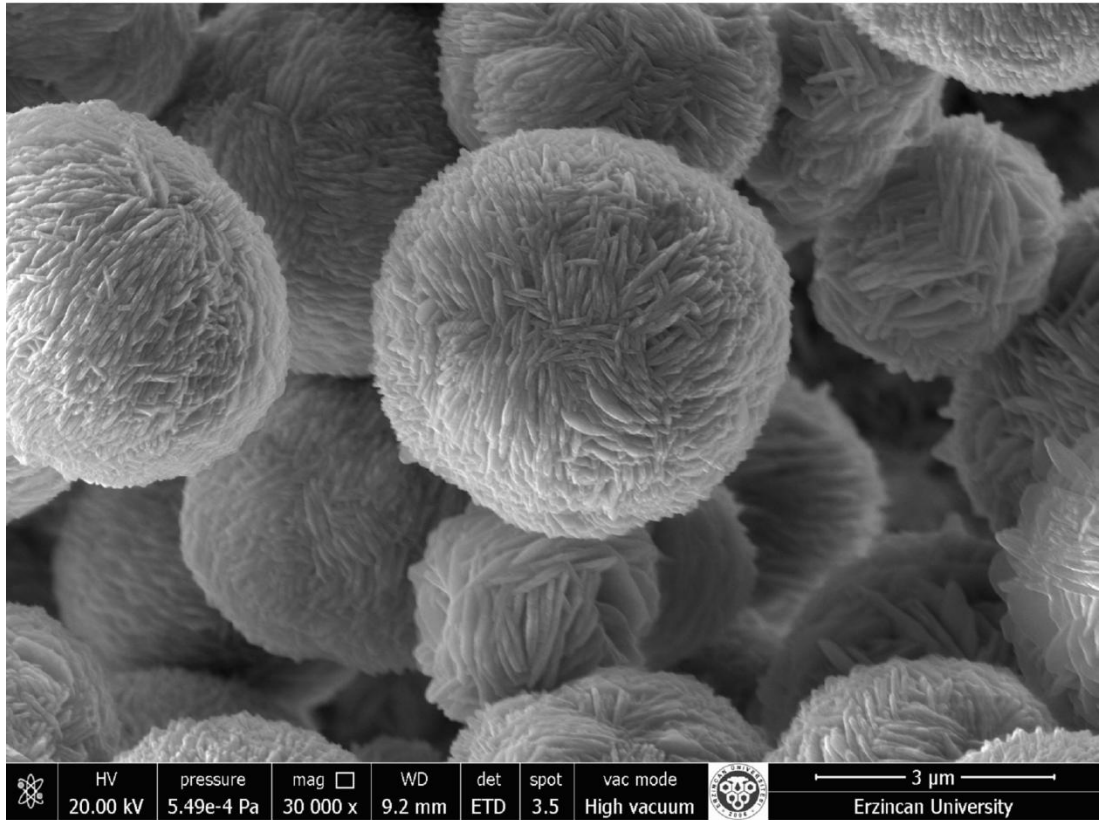
Şekil 4.6. 180 C sıcaklıkta ve 24 saat sentez süresinde elde edilen CuO filmlerin SEM görüntüleri
