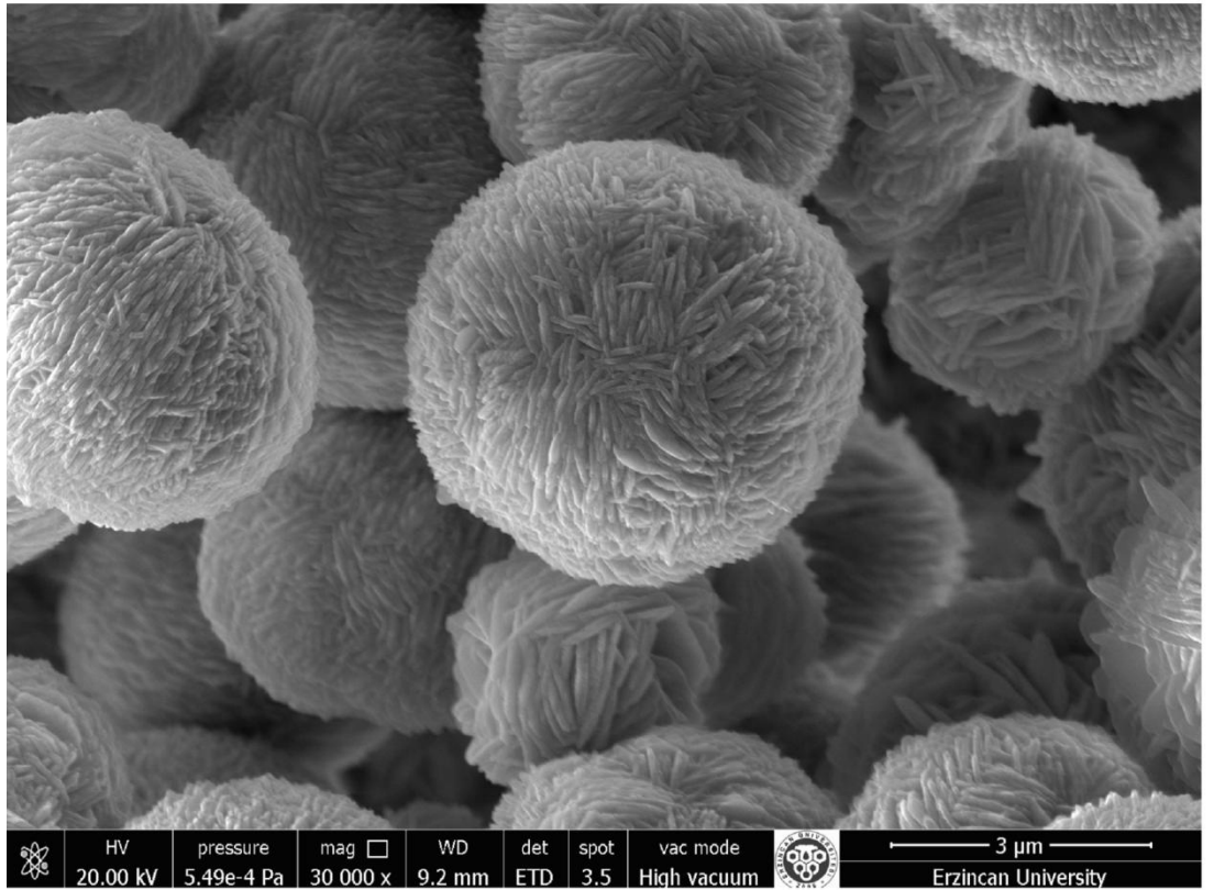
Şekil 4.10. 180 C sıcaklıkta ve 24 saat sentez süresinde elde edilen CuO filmlerin SEM görüntüleri
