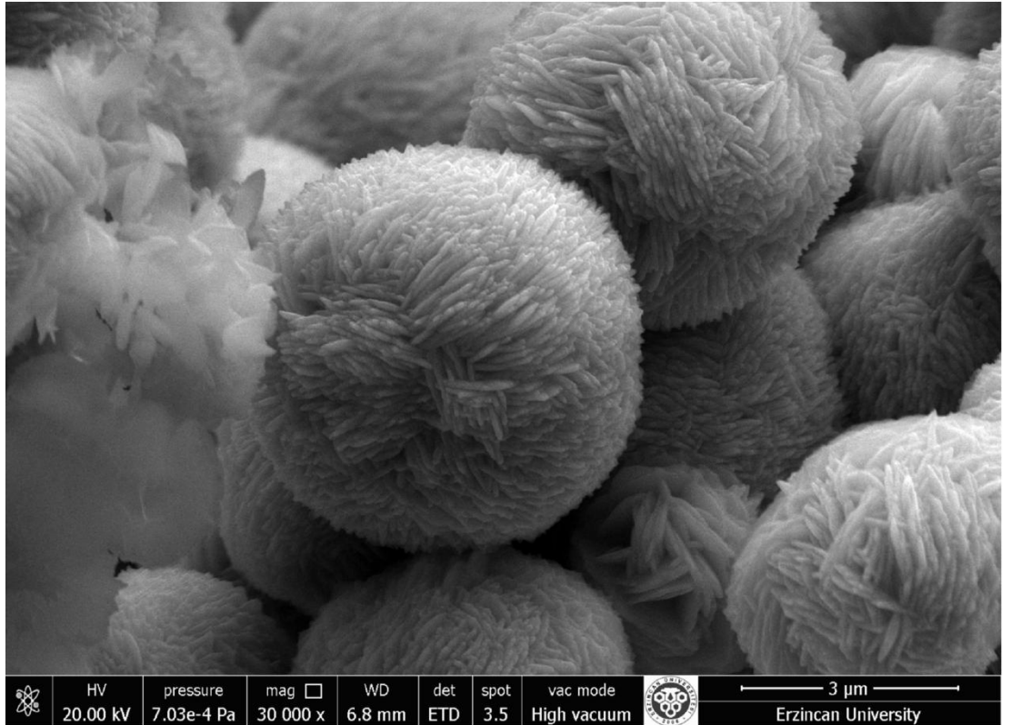
Şekil 4.5. 180 C sıcaklıkta ve 20 saat sentez süresinde elde edilen CuO filmlerin SEM görüntüleri
