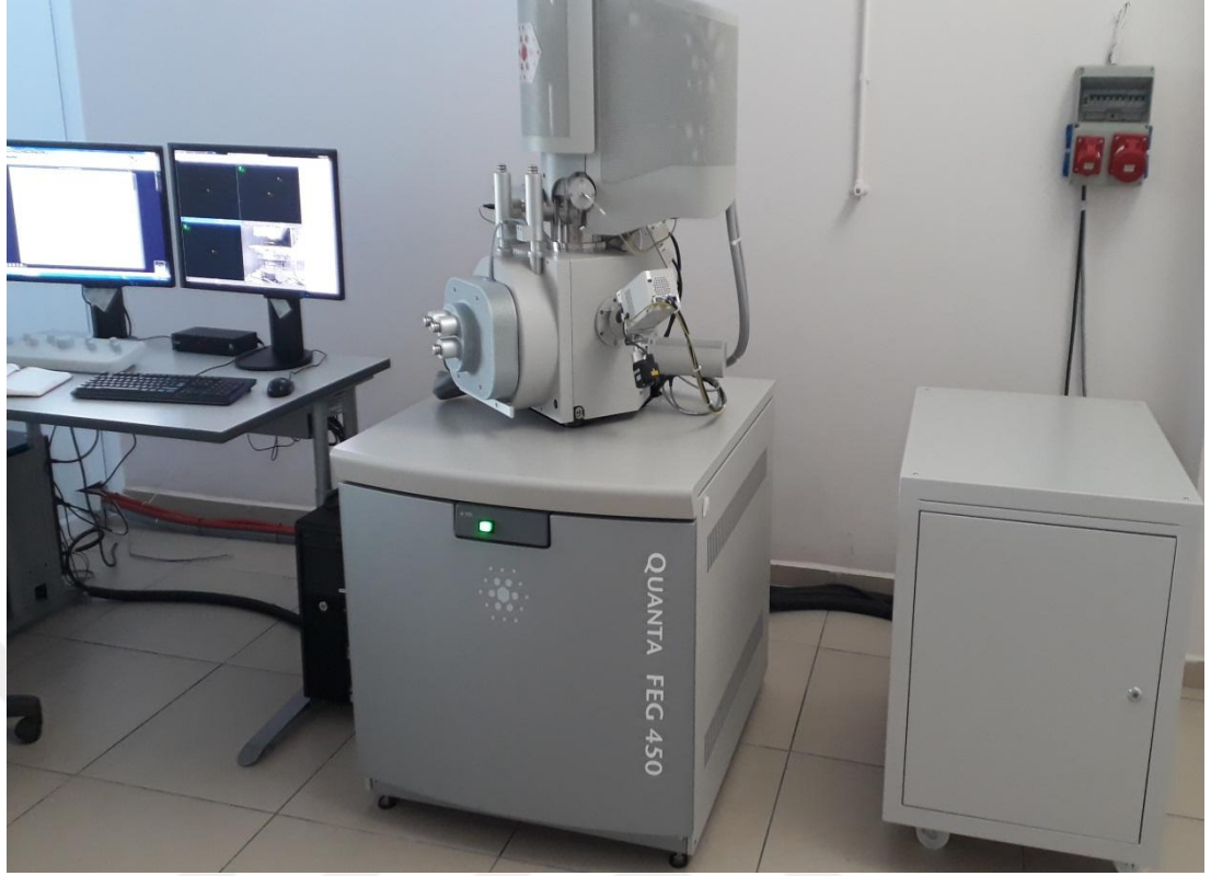
Şekil 3.10. Yüzey morfolojisini incelemek için kullanılan SEM cihazı
