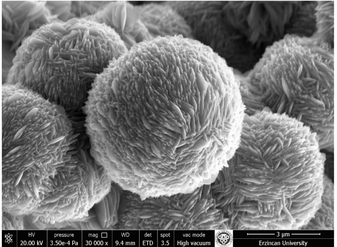
Şekil 4.9. 160 C sıcaklıkta ve 24 saat sentez süresinde elde edilen CuO filmlerin SEM görüntüleri
