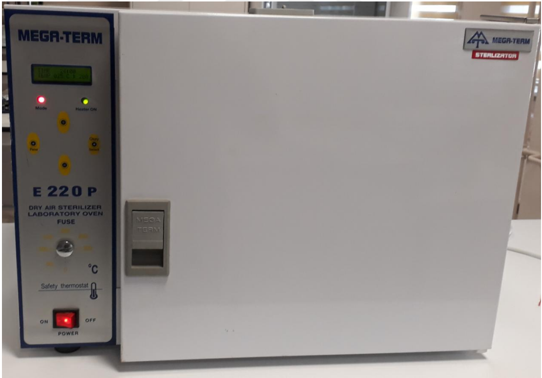
Şekil 3.5. Hidrotermal sentezlerde kullanılan sıcaklık ve zaman ayarlı fırın
