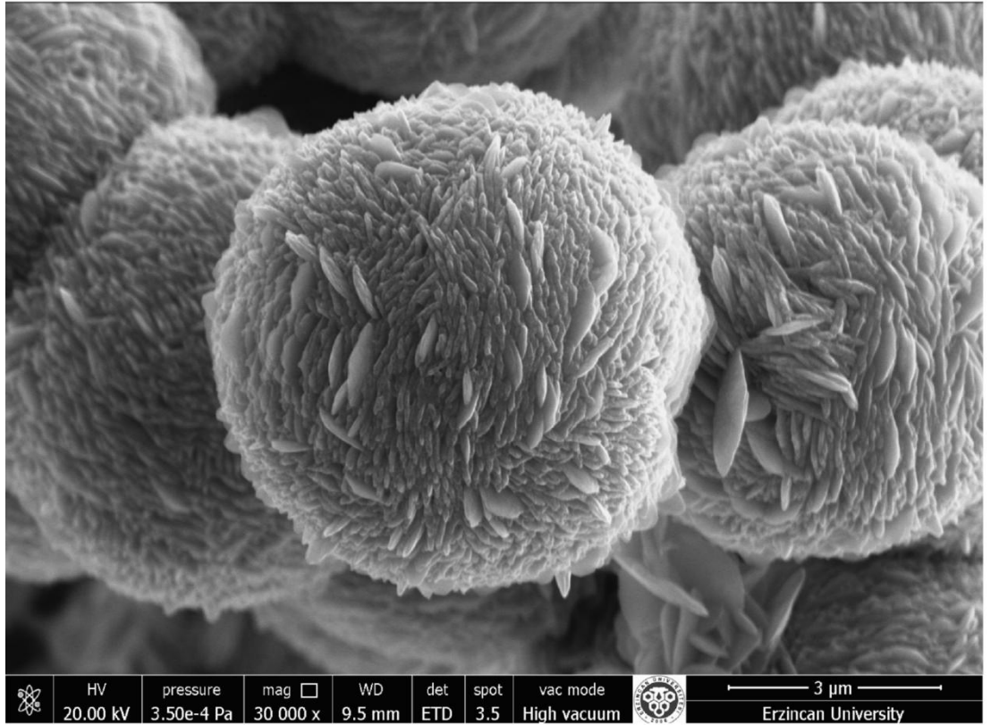
Şekil 4.11. 200 C sıcaklıkta ve 24 saat sentez süresinde elde edilen CuO filmlerin SEM görüntüleri
