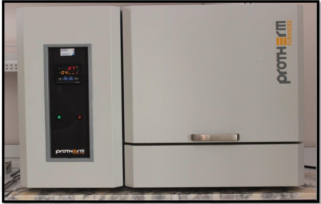
Şekil 3.3. ZnO yapıları tavlama için kullanılan Protherm marka kül fırın (Demir, 2019)
