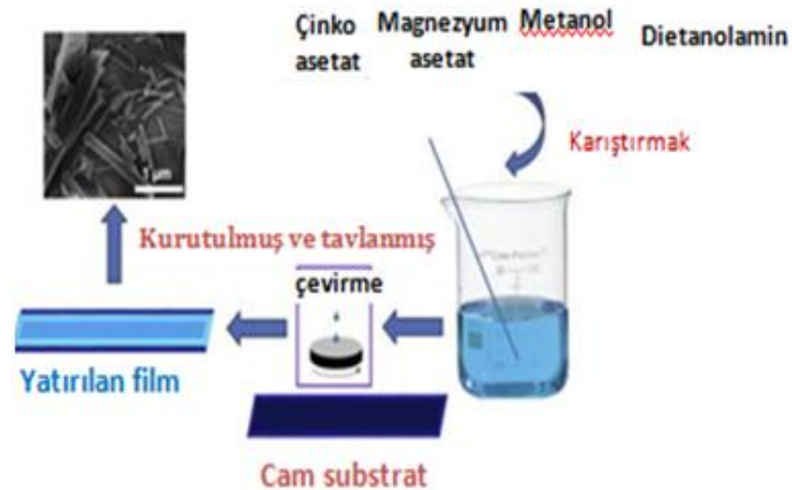
Şekil 2.11. Döndürmeli Kaplama tekniğinin şematik gösterimi (Verma vd., 2017)
