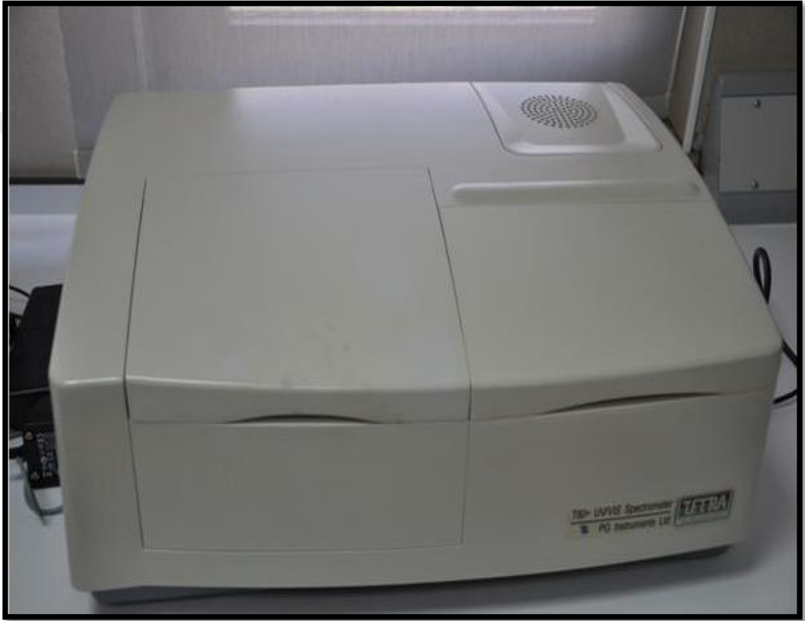
Şekil 3.7. TETRA T80 + Model Uv-Vis Spektrofotometre
