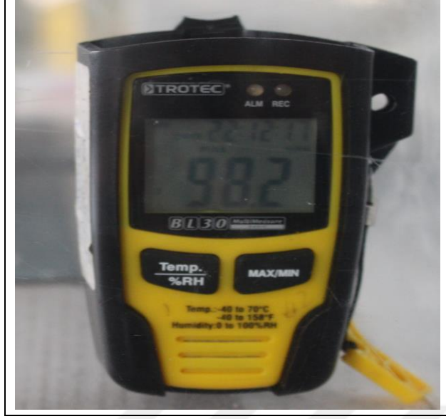
Şekil 3.2. Trotec marka nem algılama cihazı
