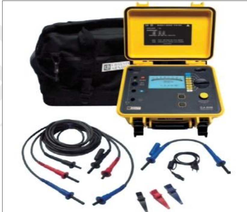
Şekil 2.40. İzolasyon test cihazı ve bağlantı parçaları (Chauvin-Arnoux internet sitesinden alınmıştır.)
