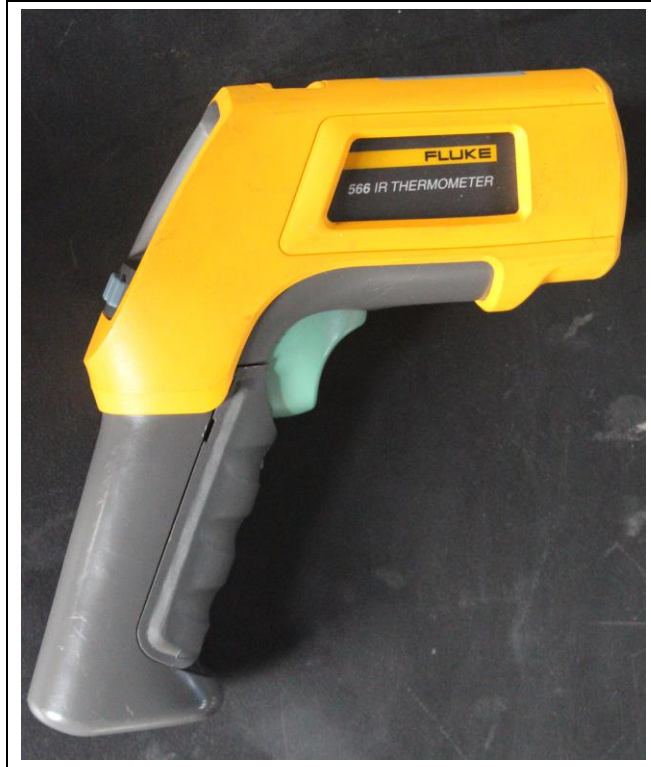
Şekil 3.3. Fluke 566 IR lazer termometre
