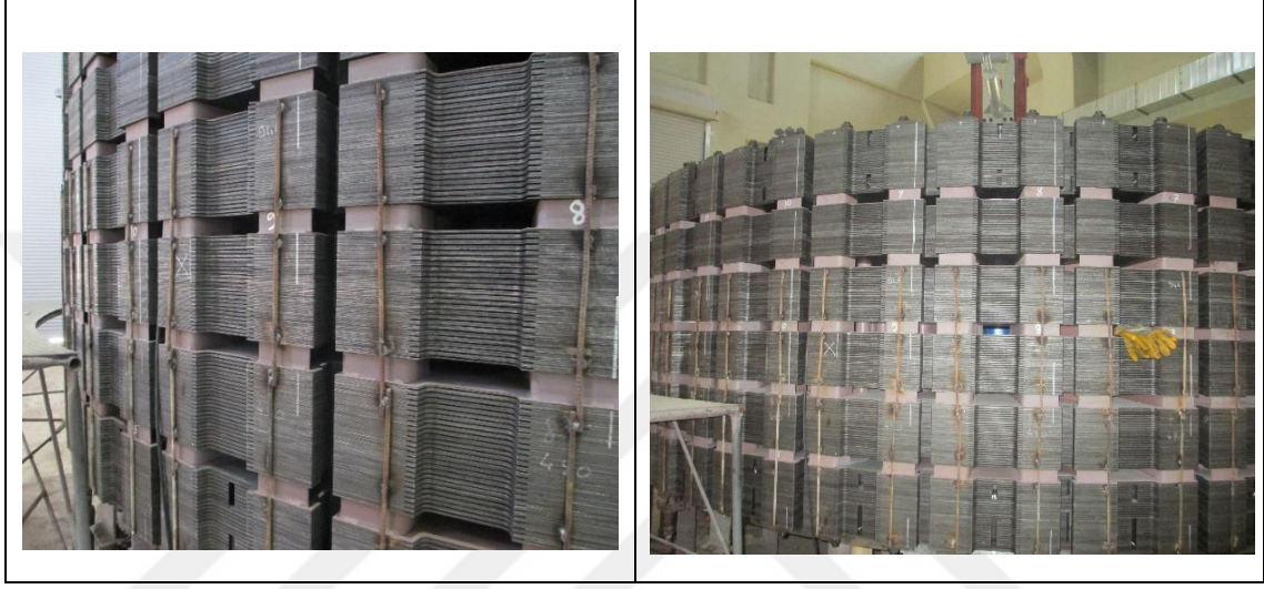
Şekil 2.8. Bağıştaş I HES Rotor Laminasyon Sacları Dizilimi
