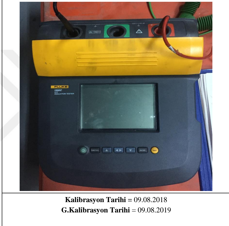
Şekil 3.1. DA İzolasyon direnci ölçüm cihazı ( Megaohmmetre )
