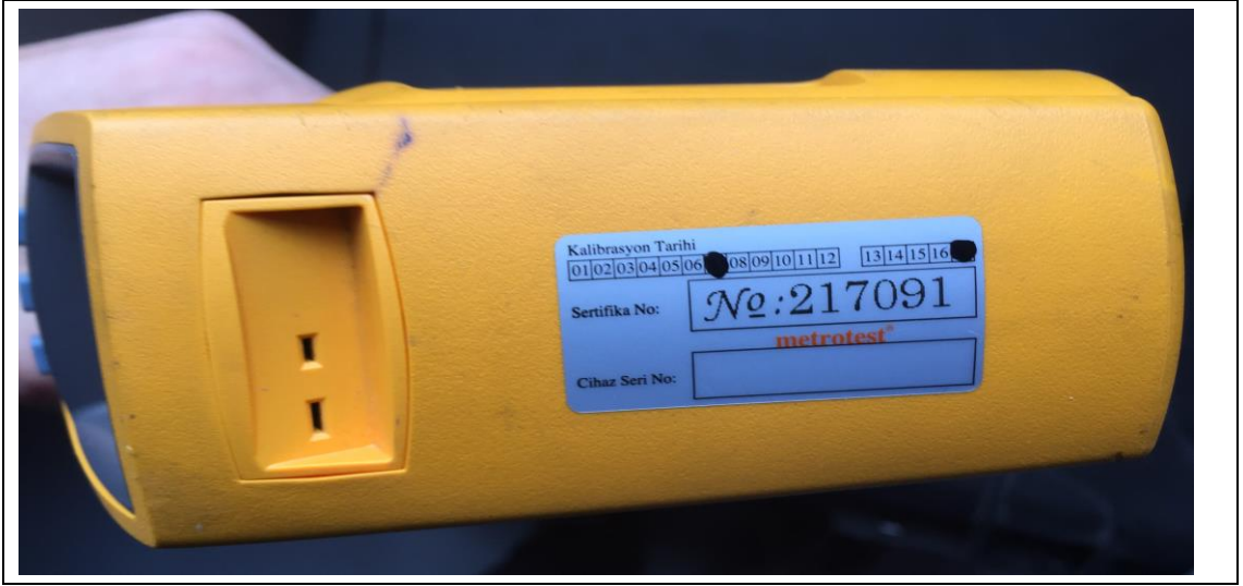
Şekil 3.4. Fluke 566 IR lazer termometre kalibrasyon etiketi
