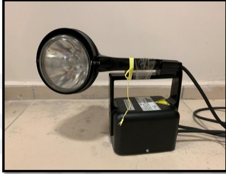
Şekil 3. 10. EÜTAM bünyesinde bulunan LZC-4X marka yüksek yoğunluklu Uv-Vis lambası
