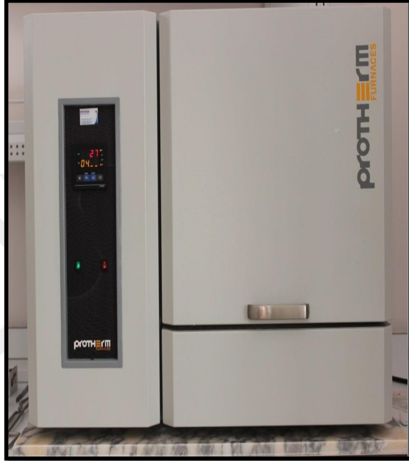
Şekil 3. 4. ZnO yapıların tavlama için kullanılan Protherm marka kül fırın
